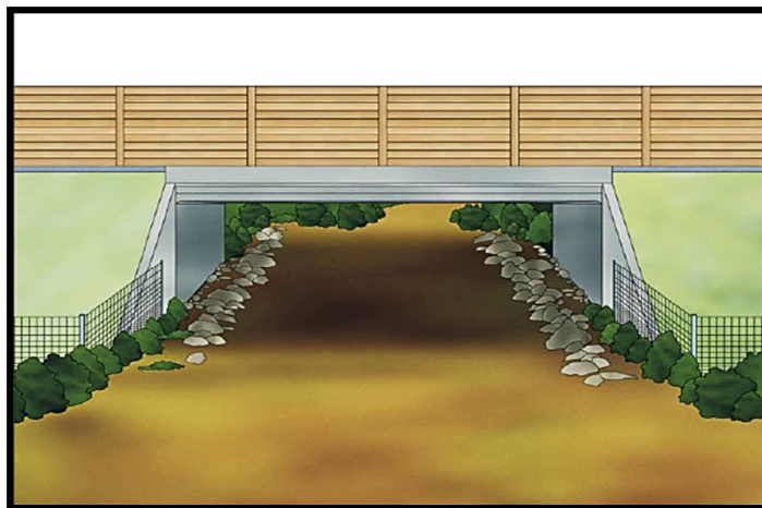
Imagen 20: Esquema recomendado para la construcción del paso inferior específico para fauna. (Ficha 6- Prescripciones técnicas para el diseño de pasos de fauna y vallados perimetrales. Ministerio de Medio Ambiente 2006).
