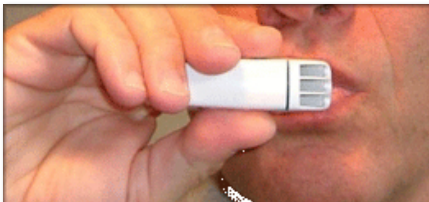
Figura 10: Un paciente realiza una maniobra de espiración forzada con el dispositivo Piko 6. Como puede apreciarse, el pequeño tamaño del dispositivo permite que el paciente lo sujete fácilmente con dos dedos.
