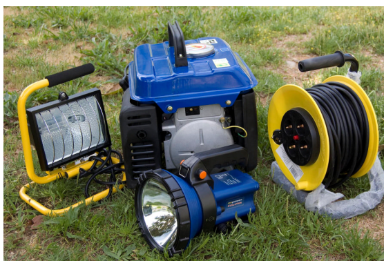
Ilustração 115 – Vista de pormenor do equipamento usado nos levantamentos noturnos, lanternas, extensão e gerador.
