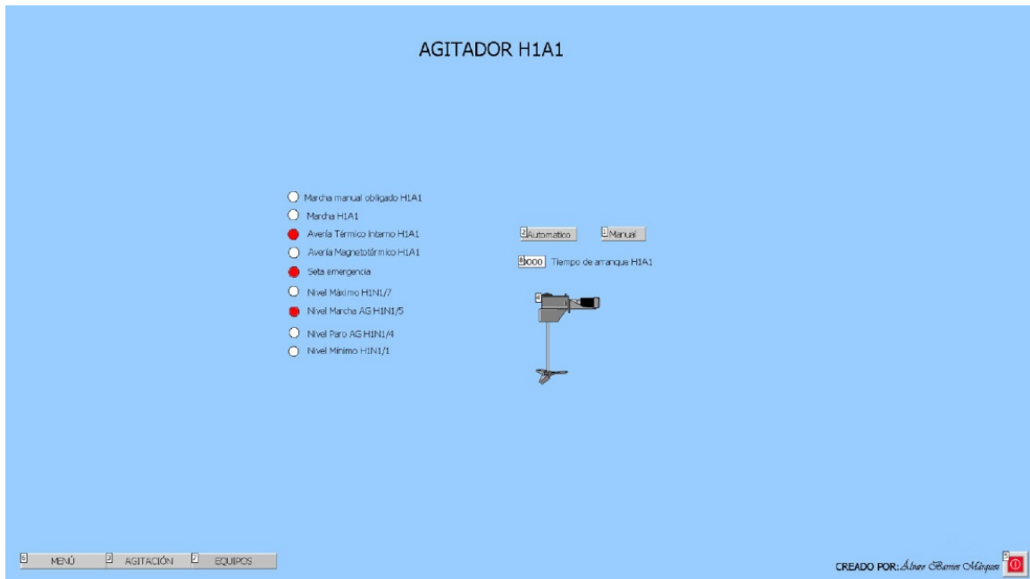
Pantalla 14: Ejemplo de pantalla de control de agitador durante su funcionamiento
