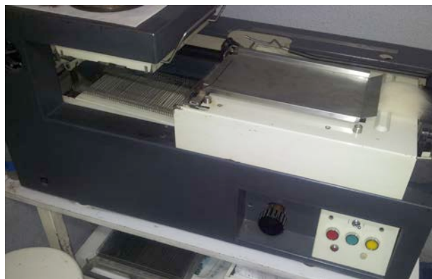
Foto 15: Pinza fibroliner con muestra de lana peinada
