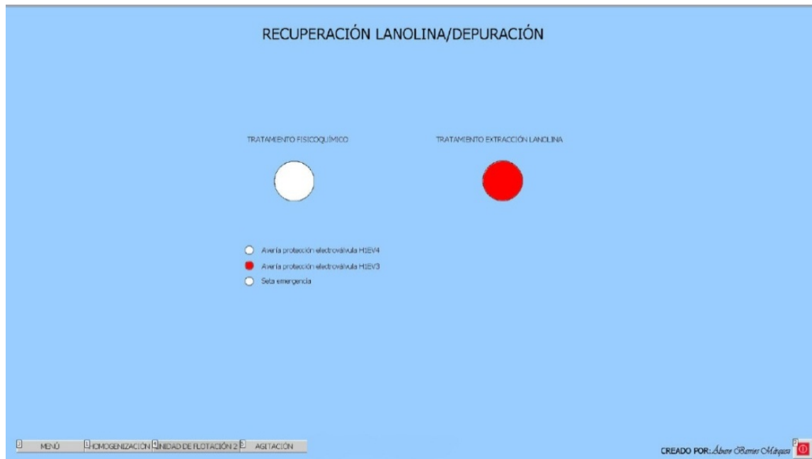
Pantalla 5: Ejemplo de pantalla selectora hacia extracción de lanolina y con visualización de avería
