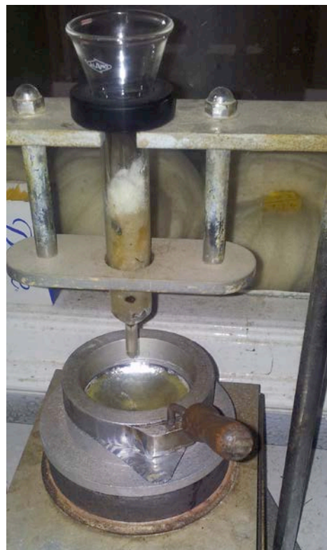
Foto 10: Desengrasado de la prueba en laboratorio
