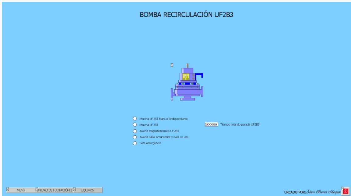
Pantalla 33: Pantalla encargada de gobernar la bomba de recirculación de la UF2
