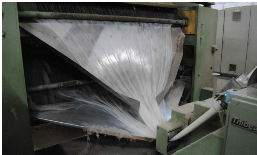
Foto 6: Velo de lana a la salida de una de las cardas
