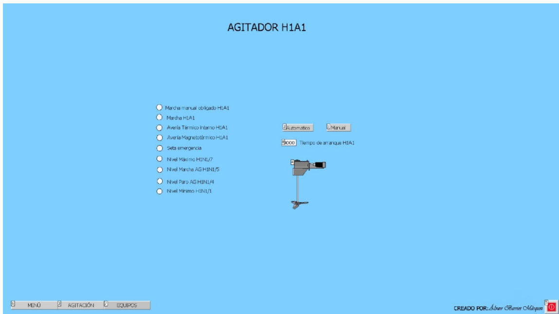
Pantalla 13: Pantalla de control y visualización de agitador 1
