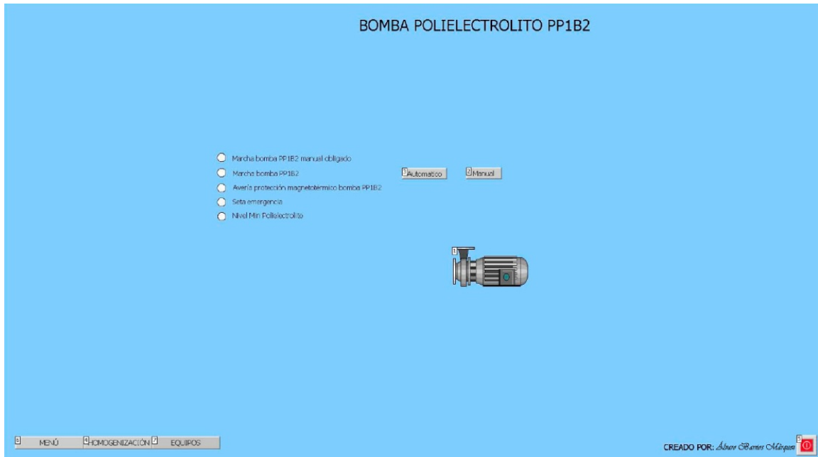
Pantalla 43: Pantalla de control diseñada para gobernar la bomba de adición de polielectrolito
