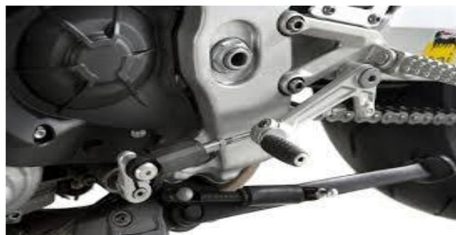
Ilustración 4: palanca de cambio de una motocicleta
