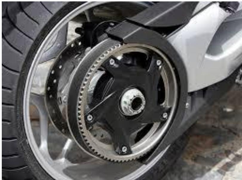
Ilustración 9: transmisión por correa dentada
