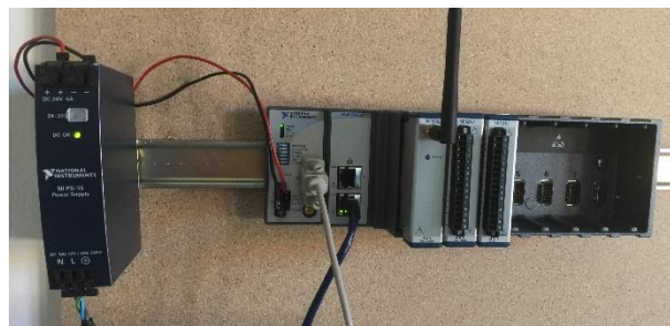
Ilustración 94: Carril DIN, fuente de alimentación y CompactRio
