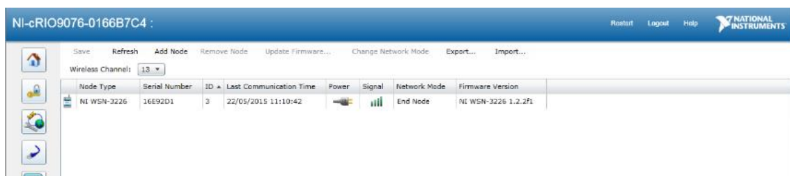
Ilustración 115: Información de la interfaz web de la CompactRio sobre un nodo WSN conectado
