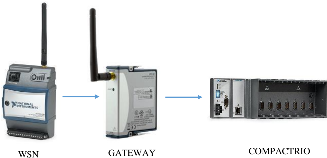
Ilustración 11: WSN conectado a COMPACTRIO, a través de GATEWAY NI 9795
