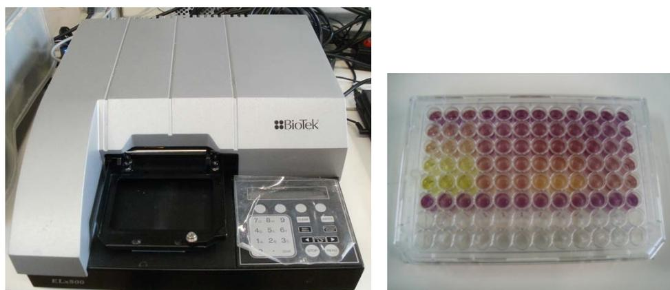
Fig. 22. Lector de microplacas y reacción de los extractos con el DPPH.
