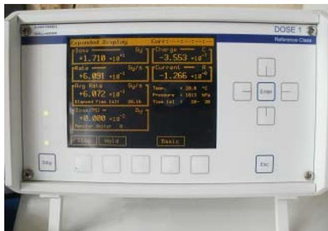
Fig. 5. Cámara de ionización y electrómetro.
