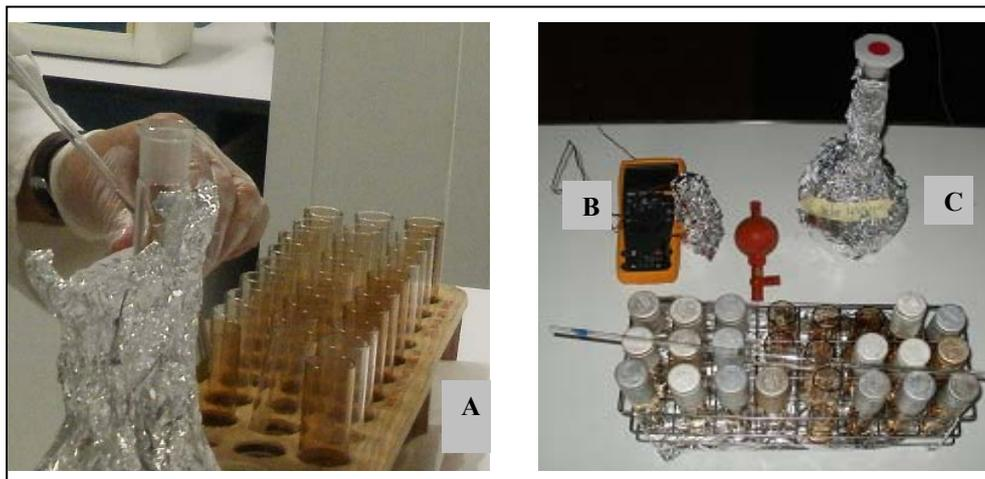
Fig. 6. Preparación del dosímetro de Fricke.
