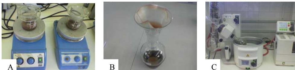
Fig. 21. Extracción (A), filtración (B) y evaporación de solventes (C).
