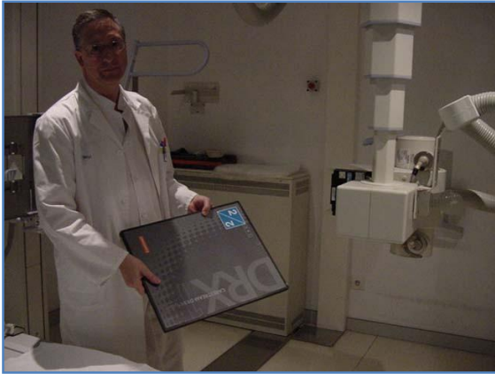
Figura 46: Receptor directo, basado en un sensor fotosensible, que reduce la cantidad de radiación necesaria para la obtención de la imagen, alrededor de un 90%.
