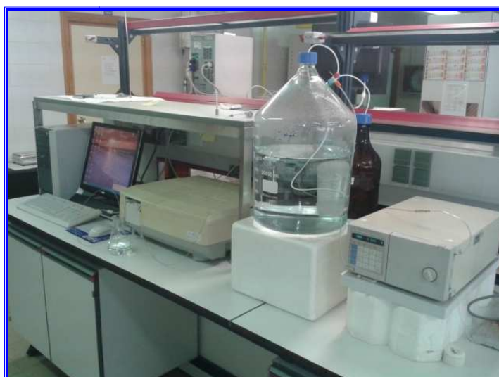
Figura 28. Instalación diseñada para el análisis cinético del proceso de adsorción.
