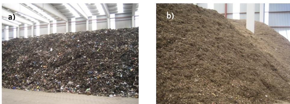
Figura 5.8. a) Bioestabilizado en etapa de maduración b) Bioestabilizado acabado
