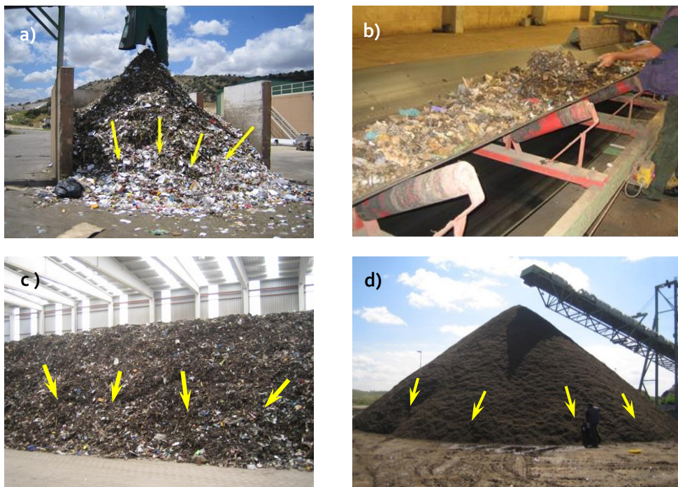
Figura 4.1. Toma de submuestras para la formación de muestras de: a) fracción orgánica b) fracción orgánica en CTR con autollenado de túnel c) bioestabilizado sin afinar d) bioestabilizado
