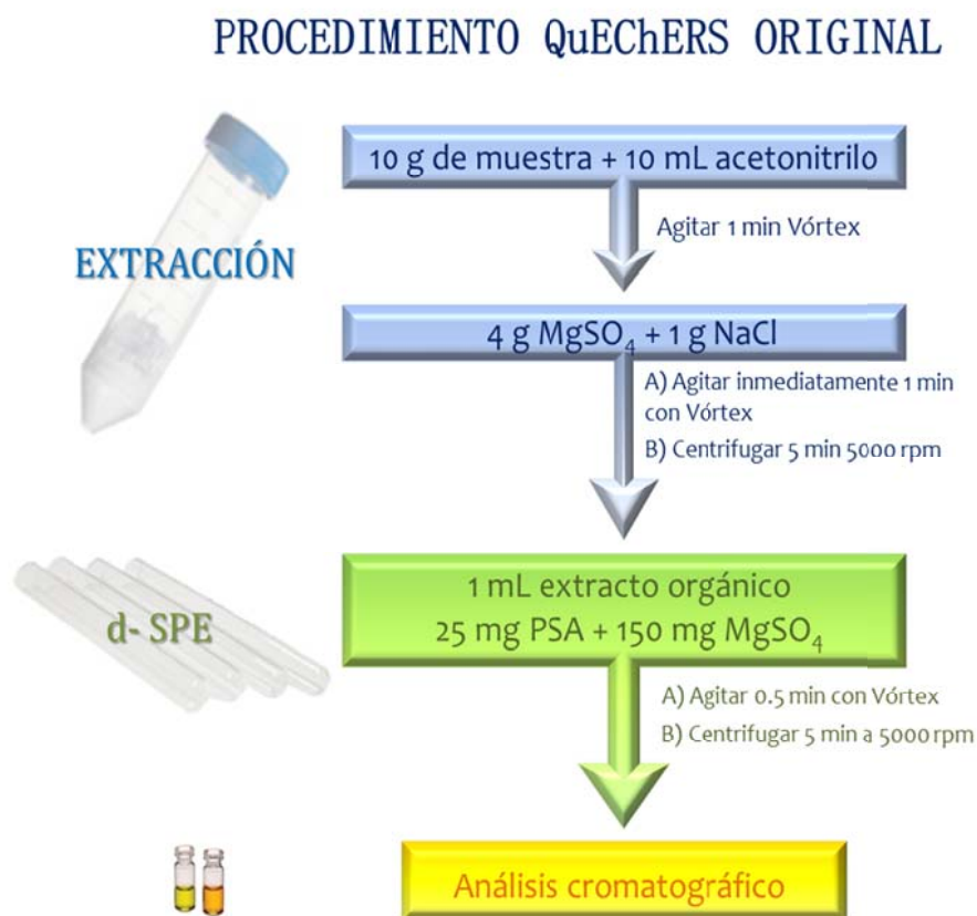
Figura 4.15. Etapas del procedimiento QuEChERS original.
