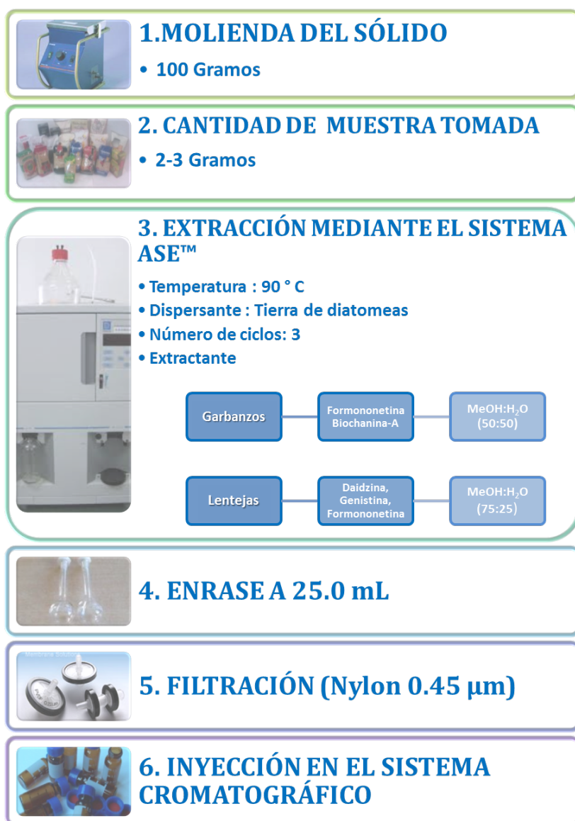
Figura 4.12. Metodología propuesta en la presente memoria para la extracción de isoflavonas utilizando el sistema ASE™ de Dionex, en muestras de legumbres.
