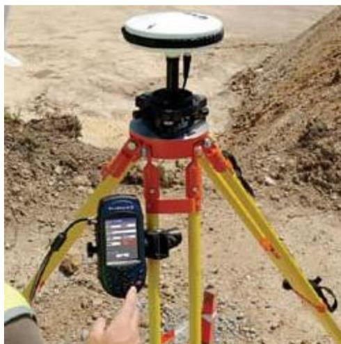
Figura 23: Medida del nivel mediante GPS
