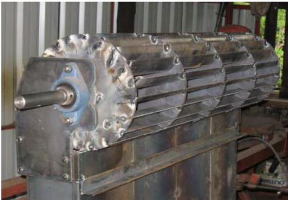
Figura 45: Turbina De Flujo Cruzado (Ossberger, 2015)
