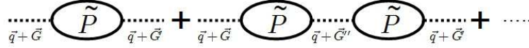
Figura 1.7: Suma de las series de diagramas solución de la ecuación Dyson (1.46) para la polarizabilidad propia \tilde{P} .
