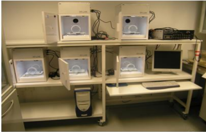
Figura 8. Equipo de medición del reflejo auditivo de sobresalto. El equipo consta de varias cámaras para realizar múltiples mediciones a la vez.
