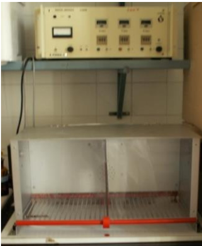
Figura 10: Caja de Mower-Miller. Sobre ella está la unidad que controla la intensidad, cantidad y duración de choques y el intervalo entre choques.
