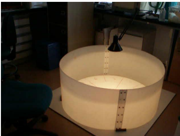
Figura 9: Vista panorámica del equipamiento usado para realizar la prueba de campo abierto (CA). La habitación donde se realiza la prueba está semi oscura, siendo el centro del CA la zona más iluminada. Las divisiones están dispuestas en círculos concéntricos que el animal puede explorar libremente. Las áreas más pegadas a la pared del cilindro constituyen la zona de exploración externa ( OA ). Las áreas internas constituyen la zona de exploración interna ( IA ).
