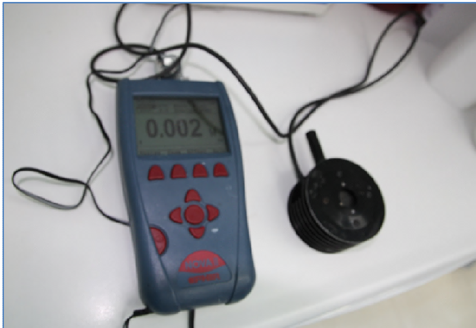
Figura 35. Calibrador Nova II De Ophir (Ophir Optronics, Massachusetts, USA). Detalle Del Medidor Y El Sensor.
