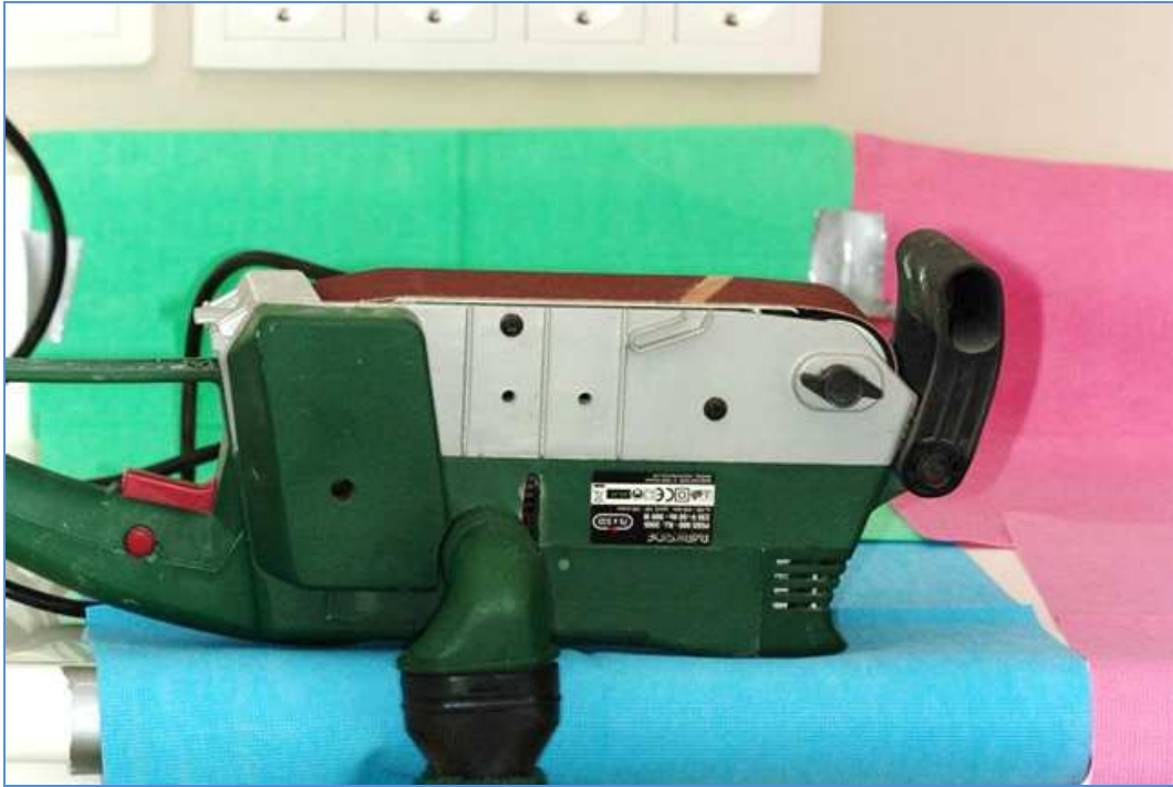
Figura 44. Lijadora Utilizada Para Obtener El Barrillo Dentinario De Las Muestras.
