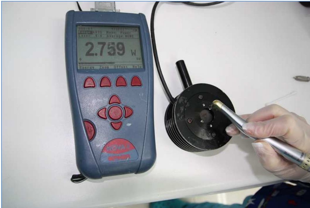
Figura 36. Detalle De La Calibración A La Salida Del Tip MC-12 Con La Golpiece Del Waterlase MD (Biolase, San Clemente, EE.UU)
