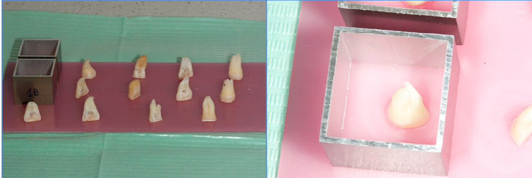
Figura 27. Fijación De Los Especímenes (Hemidientes) En La Plancha De Cera. Detalle Del Cubo De Aluminio.
