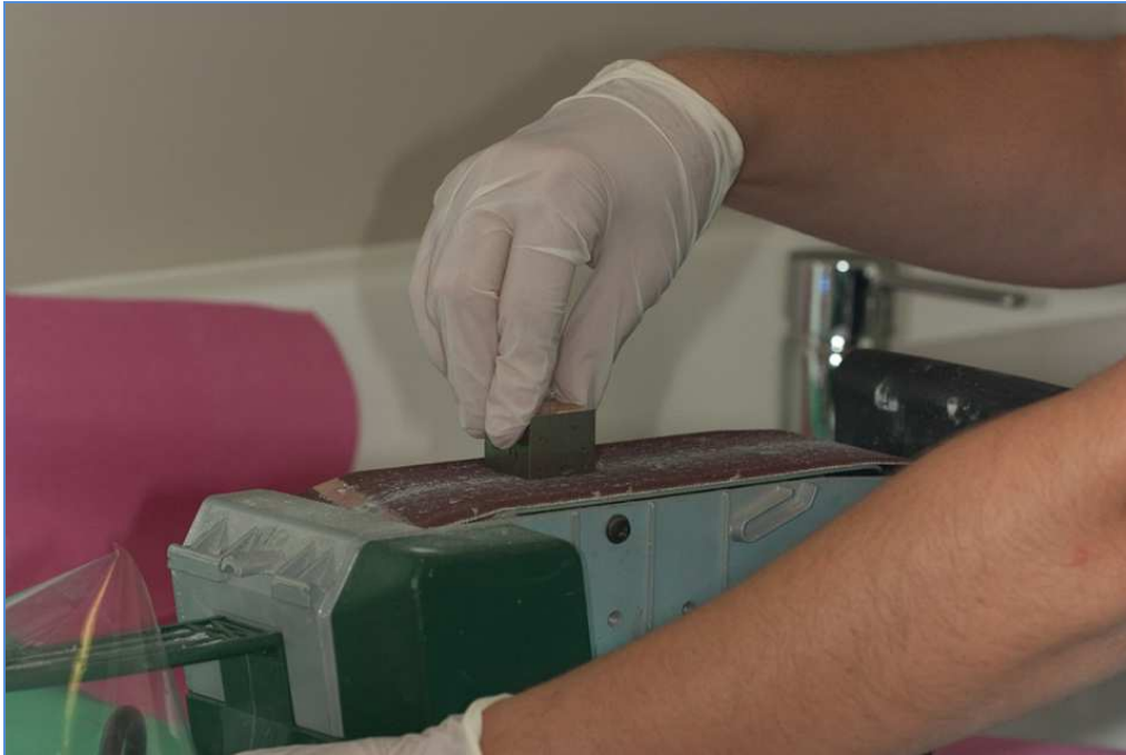
Figura 56. Detalle Del Lijado De La Muestra Procedimiento Que Se Llevó A Cabo Durante 30s. Este Fue El Primer Paso Para Las 90 Muestras Del Estudio.
