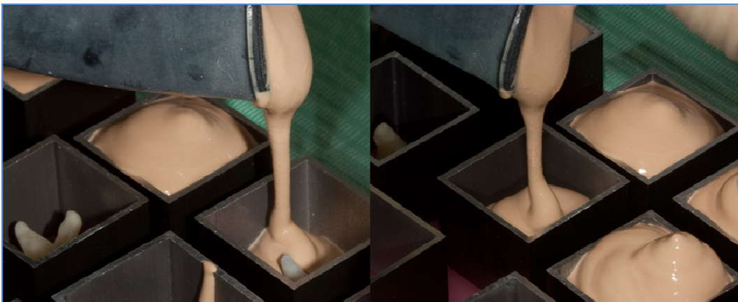
Figura 28. Detalle De La Fijación Con Yeso Piedra De Los Hemidientes En El Interior Del Cubo De Aluminio
