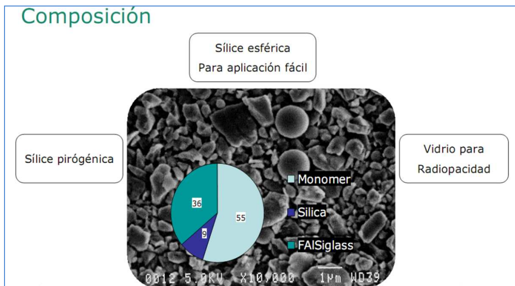
Figura 49. Composición Química De La Resina Fluida, Imagen Cortesía Del Fabricante.
