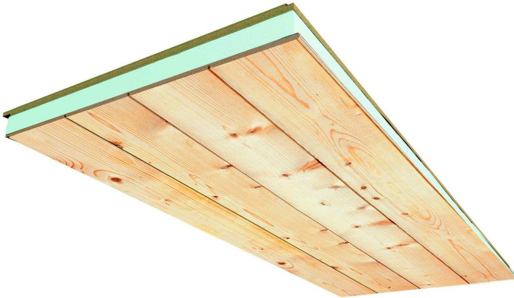
Panel aislante tipo sándwich con la cara exterior de tablero hidrófugo y la cara interior en abeto natural acabado tipo tarima de gran anchura de paso (137,5 mm) que confiere al panel una total estabilidad dimensional y un acabado estético de prestigio y calidad premium.
