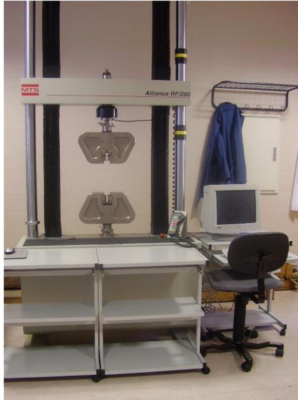
Fig. 2.3. Máquina de ensayo universal servomecánica MTS modelo Alliance RF/200.
