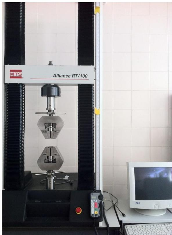
Fig. 2.2. Máquina de ensayo universal servomecánica MTS modelo Alliance RT/100.
