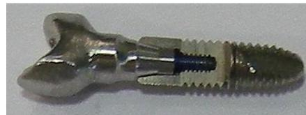
Figura 3.11 Implante seccionado para ver la conexión
