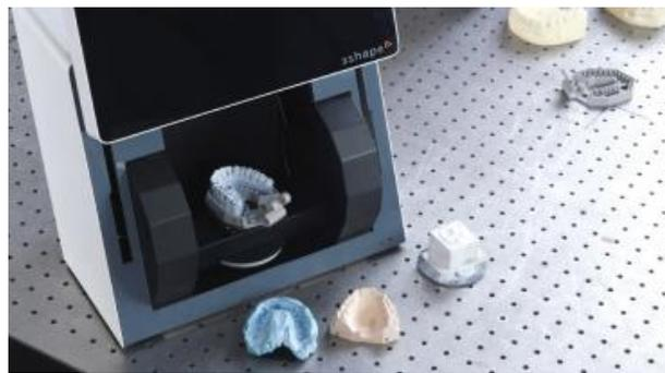
Figura 1.58 Escaneo de modelo tras el vaciado de la impresión
