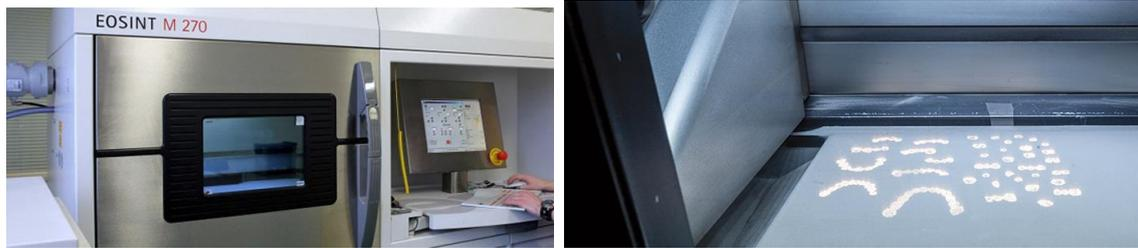
Figura 1.68 Sinterizadora e incidencia del láser sobre el polvo
