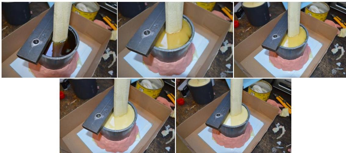
Figura 65. Proceso de endurecimiento de la mezcla de resina de poliuretano
