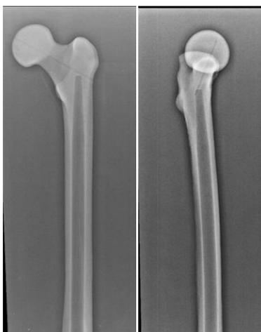
Figura 54. Rx Ap y Lat de hueso Sawbones® intacto. Se aprecia el canal medular
