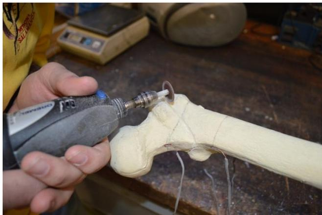
Figura 68. Detalle del proceso de corte para simular la fractura con la sierra Dremel®
