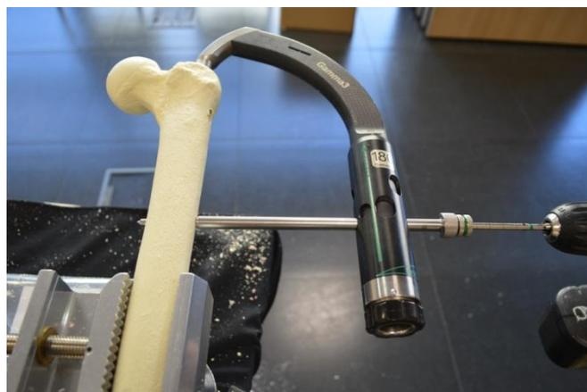
Figura 50. Realización de orificio para tornillo de bloqueo distal
