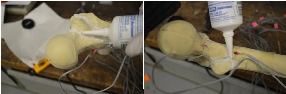
Figura 70. Aplicación de silicona para fijar las fracturas
