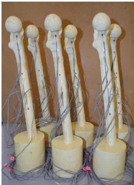
Figura 87. Fémures con las galgas colocadas
