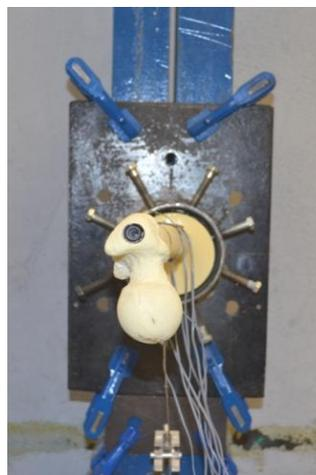
Figura 92. Sistema de transmisión de carga
