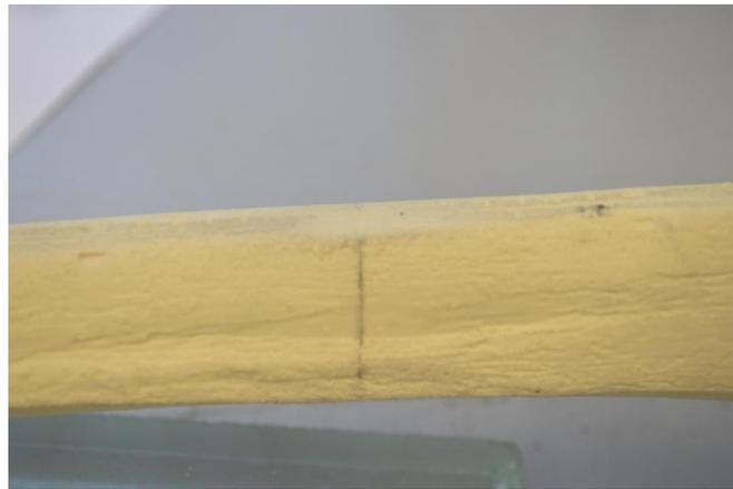
Figura 84. Zona del fémur lijada y preparada para el pegado de la galga
