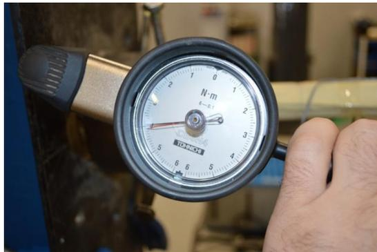
Figura 91. Llave dinamométrica analógica; Par 4Nm
