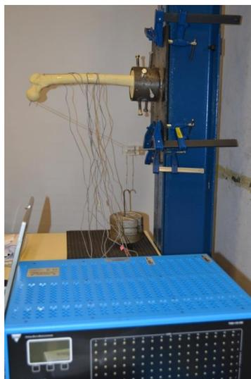
Figura 95. Carga máxima de 7.5kg antes de cortar el cable
