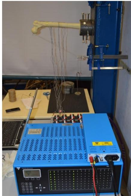
Figura 89. Montaje de la muestra con el equipo de medida
