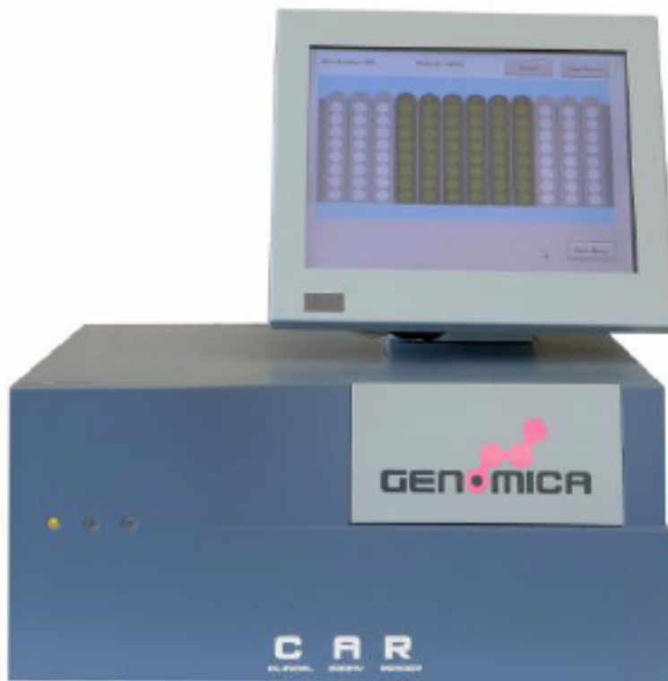
Figura 8: CAR (clinical array reader): lector de las placas con los pocillos.
