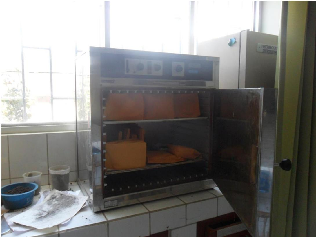
Fotos 14 y 15: Muestras debidamente acondicionadas y etiquetadas para su secado en estufa; nótese el rebrote a partir de tocones en el bosque de *Eucalyptus globulus* (Catac).
