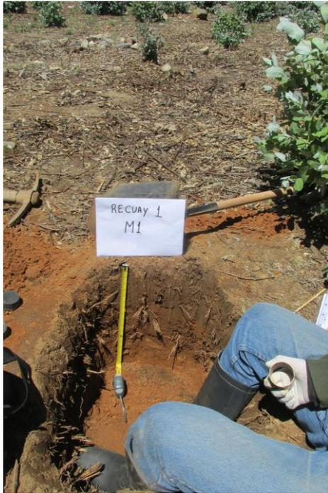
Foto 20: Muestreo de suelos a prof. de 0.0 a -0.25 m y -0.25 a -0.50) en el Bosque de *Eucalyptus globulus* en Catac; nótese el cilindro para el muestreo de la densidad aparente.
