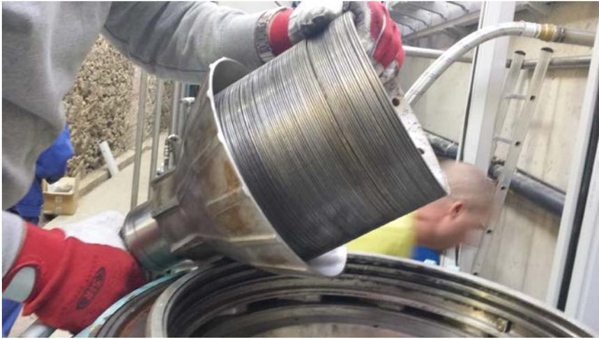
Imagen 3.3. Vista del paquete de discos de una centrífuga en el momento de su extracción para su limpieza
