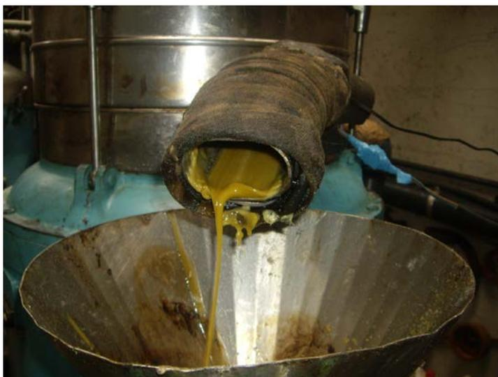
Imagen 4.13. Recogida de lanolina en un embudo a la salida de la segunda centrífuga para su almacenamiento
