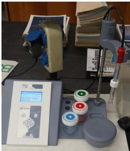
Imagen 6.10. En primer plano: pHmetro digital para el control de la prueba
