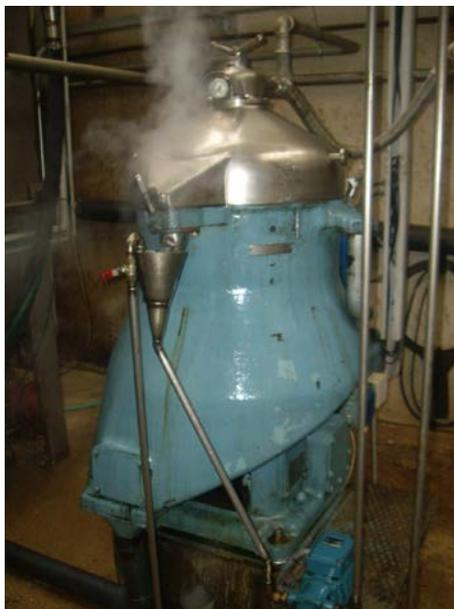
Imagen 4.8. Separadora centrífuga ALFA LAVAL C 209
