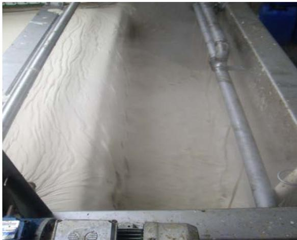
Imagen 4.11. Rasqueta del DAF llenando el espesador de grasa antes de su entrada en el tanque de craqueo térmico
