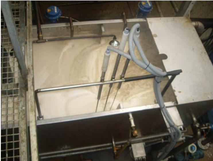
Imagen 4.12. Tanque de craqueo térmico
