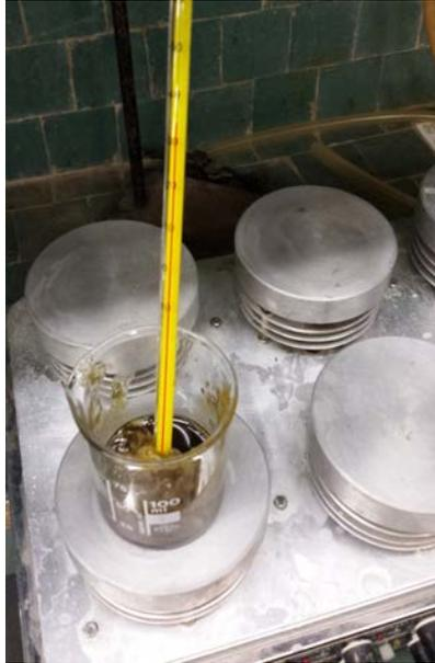
Imagen 6.5. Vaso de precipitados sobre calefactor de placas para medir el punto de fusión
