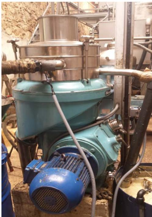
Imagen 4.9. Separadora centrífuga ALFA LAVAL C 207
