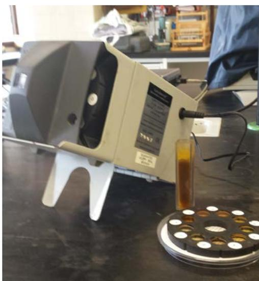
Imagen 6.12. Equipo comercial para medida del color según la escala Gardner
