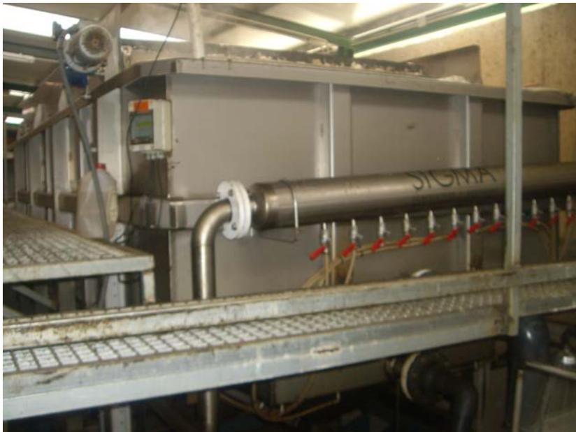
Imagen 4.3. Equipo de flotación DAF. Vista del colector de mezcla aire – agua
