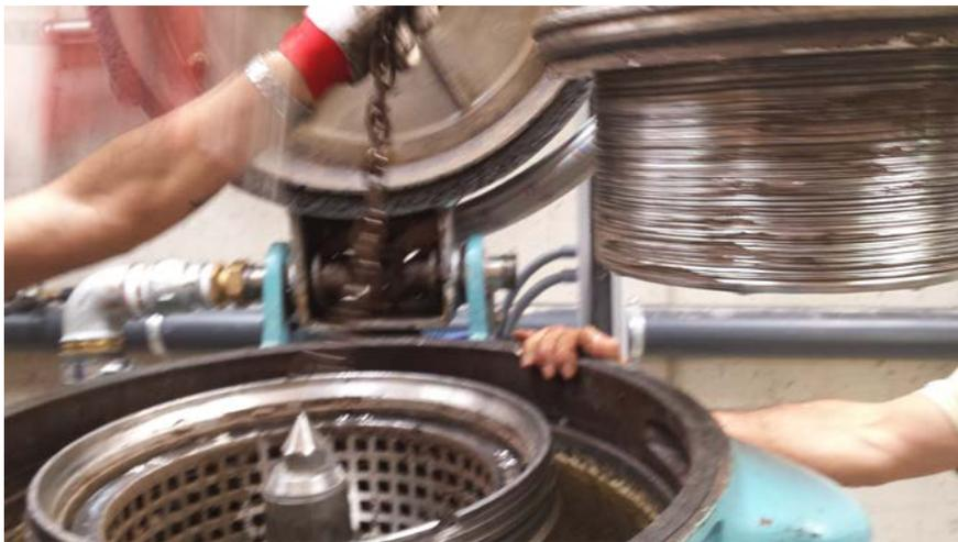
Imagen 3.4. El mismo paquete de discos en el momento de su colocación dentro de la separadora centrífuga
