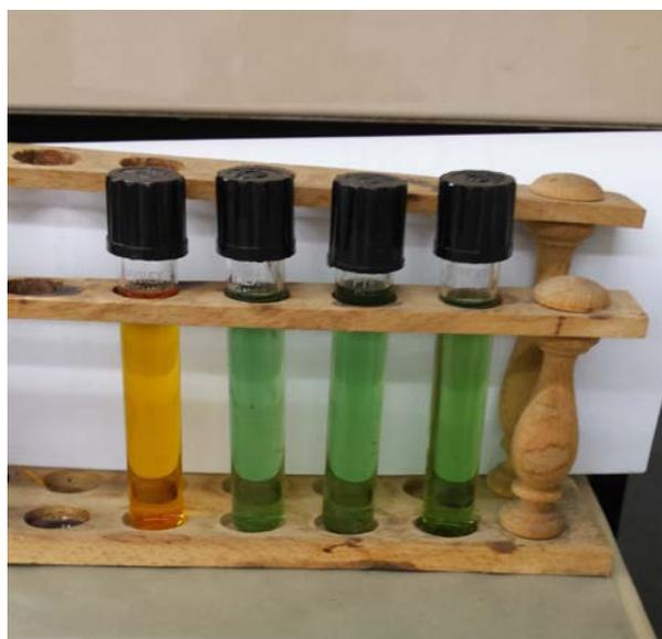
Imagen 5.2. Ejemplo de preparación de las muestras de agua para analizar su DQO. Tubos para la digestión del agua residual (color verde), junto con un “blanco” de agua destilada (color amarillo)
