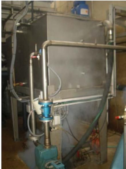
Imagen 4.7. Tanque de craqueo térmico
