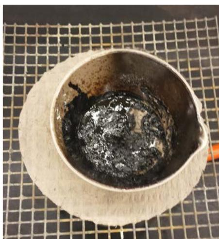
Imagen 6.9. Cenizas tras la combustión de la muestra de lanolina
