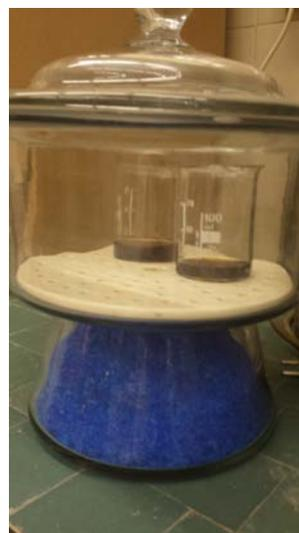
Imagen 6.7. Muestras en el interior del desecador
