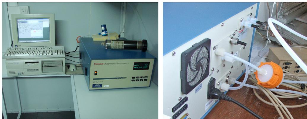
Figura 3.2. Izquierda: instrumento instalado en el interior del LABEL. Derecha: detalle del filtro de partículas conectado a la entrada ‘Sample’
