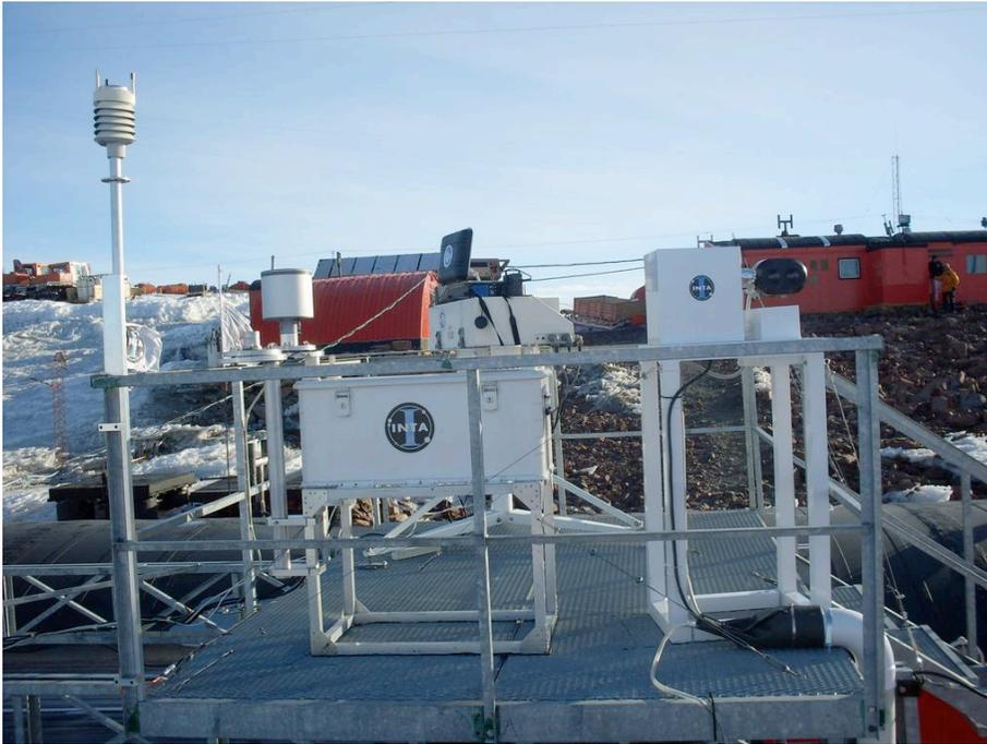
*Figura 3.6. Estación meteorológica en la terraza del LABEL.*
