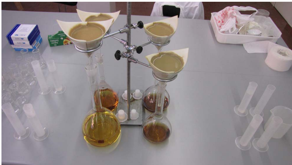
Figura 3.10 – Fase de filtración de la suspensión inmediatamente después de la extracción.
