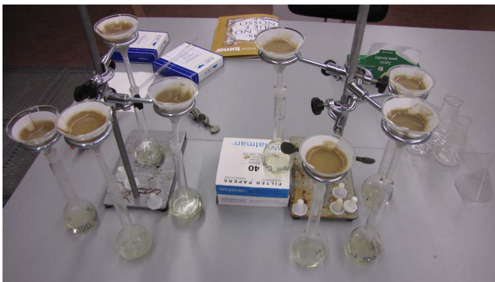
Figura 3.14 – Filtración para determinación del As, Fe y Mn asimilables.
