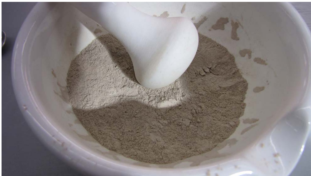
Figura 3.12 – Pulverización y homogeneización del residuo extractado seco.
