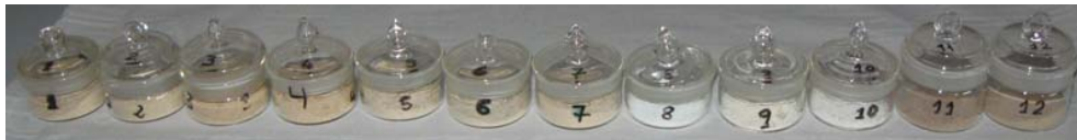
Figura 3.1 – Determinación del porcentaje de humedad en pesasustancias.
