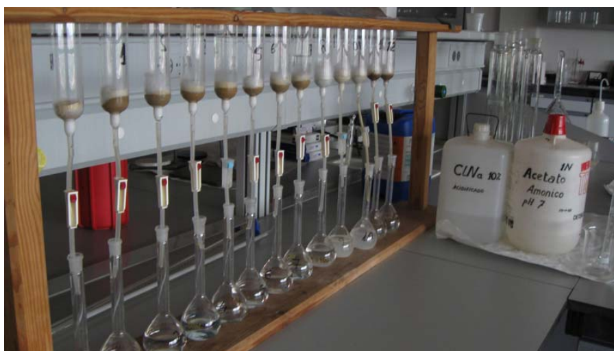
Figura 3.5 – Percolación y recogida del lixiviado.
