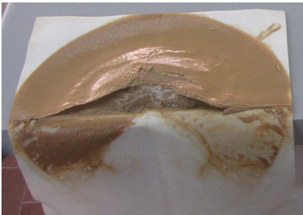
Figura 3.11 – Residuo al final de 12 horas de filtración.
