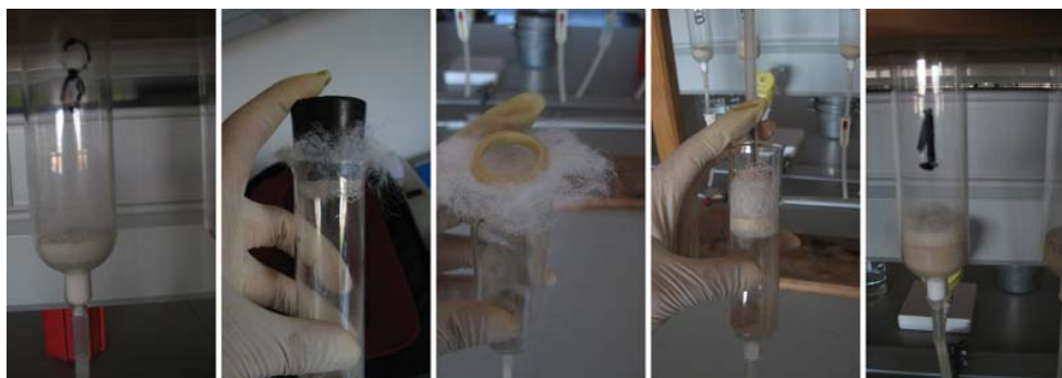
Figura 3.4 – Preparación de los tubos de percolación.
