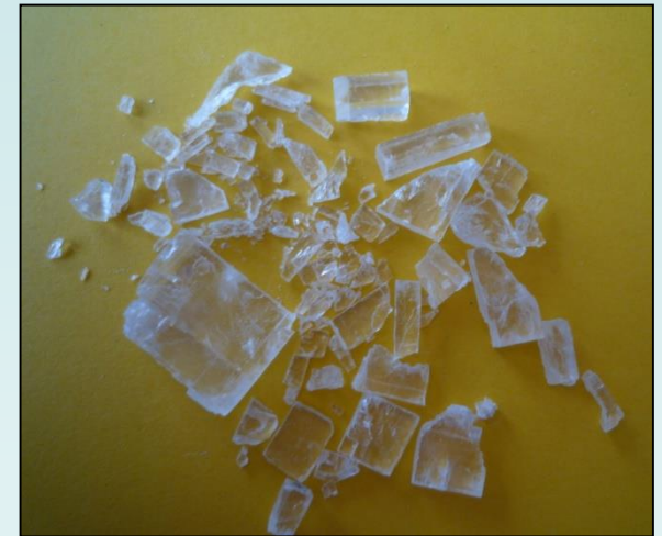
Si le damos un golpe, se rompe en trozos en los que podemos distinguir los 3 planos fundamentales de un cubo
