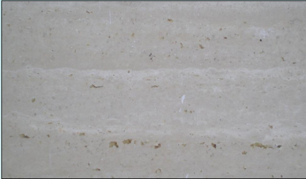
Placa pulida con los huecos rellenos de resina transparente
