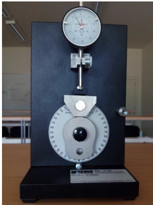
Fig. 4. Montaje experimental: reloj comparador, disco graduado, leva de dos detenimientos y seguidor de cara plana
