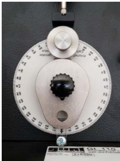
Fig. 3. Disco graduado, leva de dos detenimientos y seguidor de rodillo
