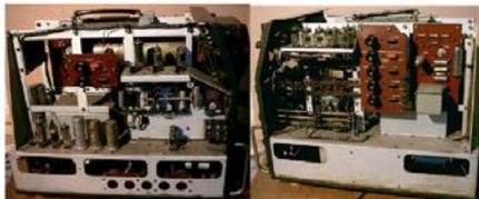
Figura 4. Interior del Osciloscopio Cosmor 1035. Externamente es similar al Cosmor 1049. Sin embargo, a nivel interno, es un modelo muy mejorado que utiliza válvulas de vacío en miniatura lo que se refleja en el rendimiento significativamente mejorada respecto al modelo 1049.
