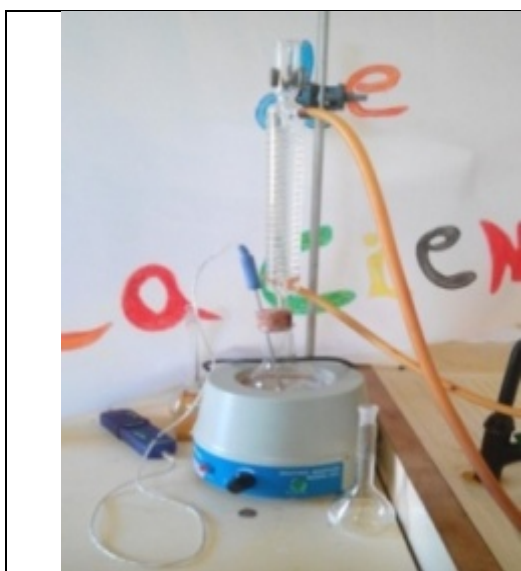
Figura 4a: Montaje para calcular las temperaturas de ebullición
