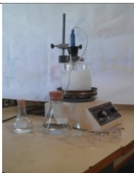
Figura 4b: Montaje para calcular las temperaturas de congelación
