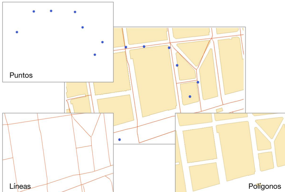
Figura 2.4 Elementos de abstracción geométrica utilizados en cartografía
