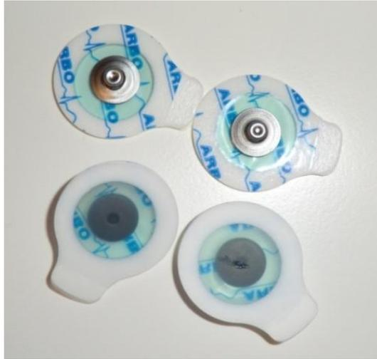
*Figura 6. Electrodo de superficie desechable. Uno de los lados contiene gel para la transmisión de la señal y un fijador que hace más eficiente la adhesión a la piel, evitando que se despeguen.*
