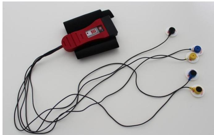
*Figura 8. Modelo de Bioamplificador QPET 2 Brainquiry con electrodos de superficie y los dos canales (2 electrodos azules que son positivos y 2 amarillos que son negativos) y un electrodo (color negro) que es el de referencia.*
