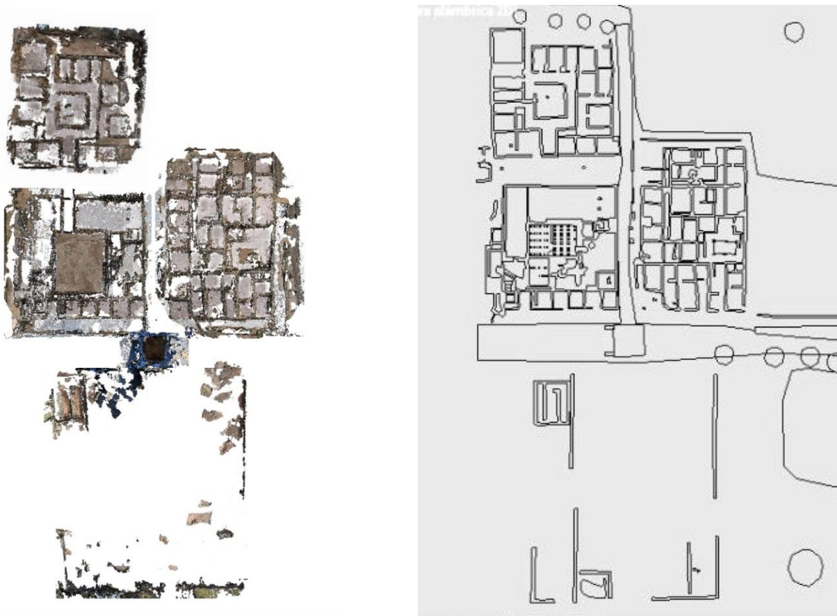
Figura 2.4.1. Nube de puntos y vectorización.
