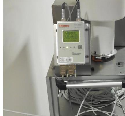
Figura 47. Estación de monitorización FHT 6020-A
