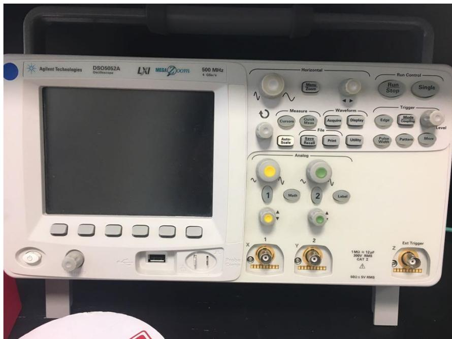
Figura 117. Osciloscopio DSO5052A de Agilent.
