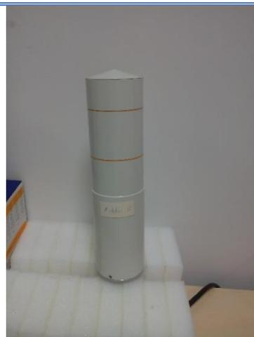
Figura 48. Sonda de monitorización FHZ-621 G-L4.
