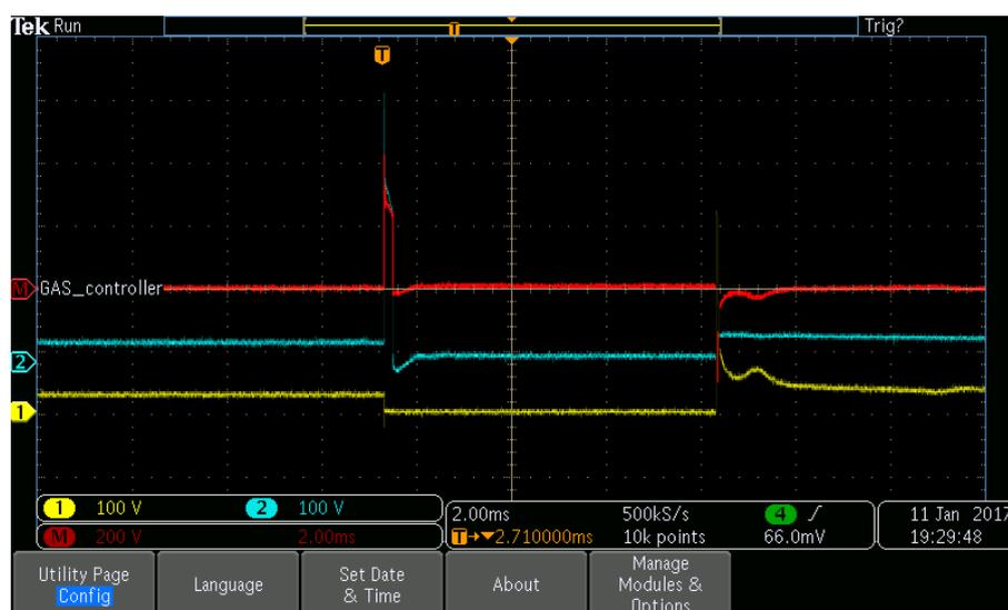
Figura 173. Señal del controlador de entrada de gas en cámara de experimentación en condiciones normales.
