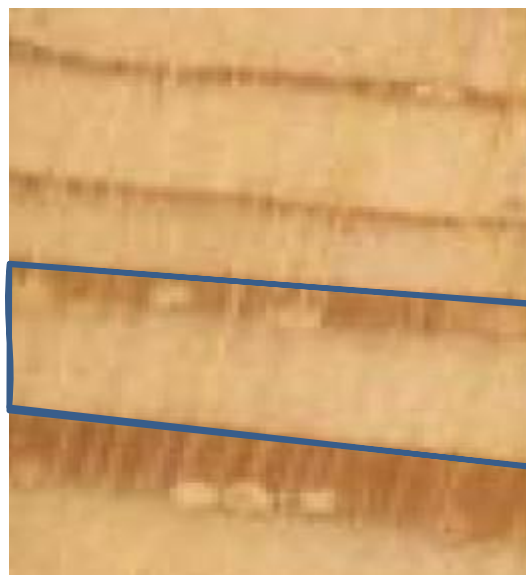
Figura 2. Vista de una sección transversal de madera de pino. El área marcada es un anillo que está formado por dos bandas, una clara y otra oscura. Los anillos que aparecen en la parte inferior de la imagen son los primeros que se formaron.
