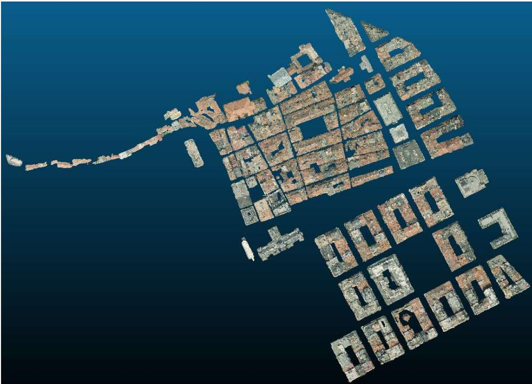
*Figura 43: Nube de puntos tras la extracción de tejados*
