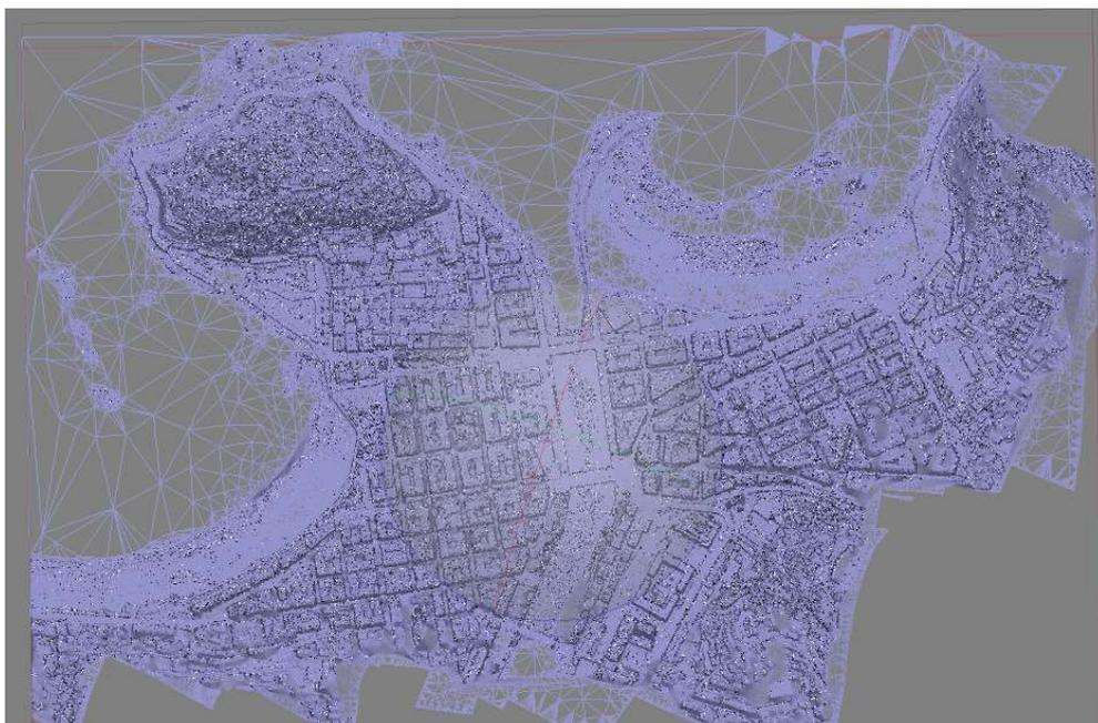
*Figura 13: Generación malla PhotoScan*
