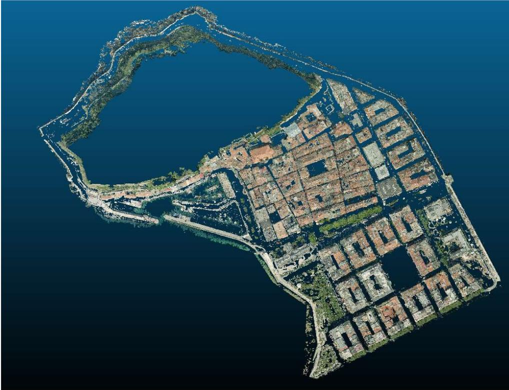
Figura 32: Clasificación puntos "no-terreno"
