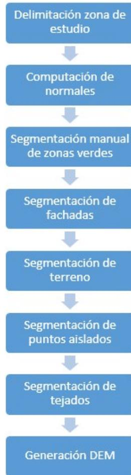
Figura 21: Flujo de trabajo para extracción de cubiertas
