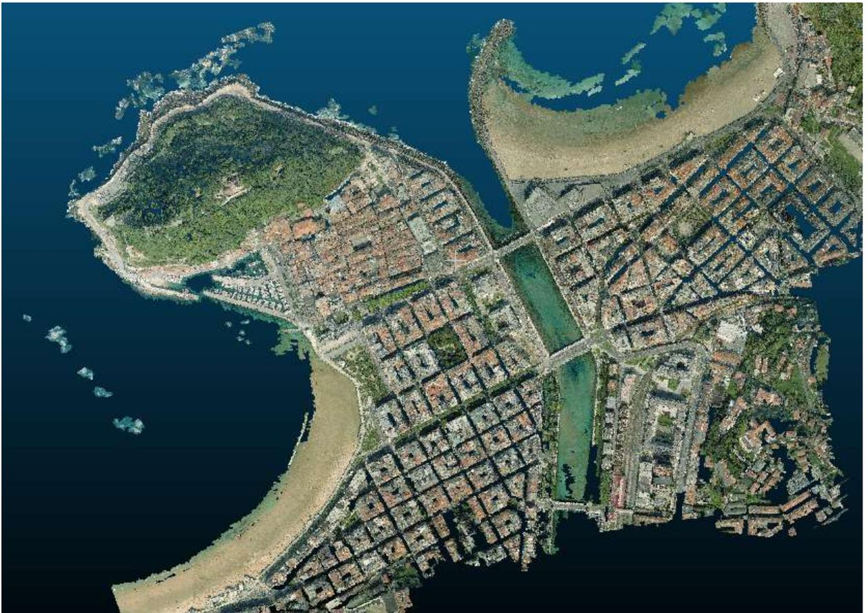
*Figura 20: Nube de puntos georreferenciada a partir de oblicuas*
