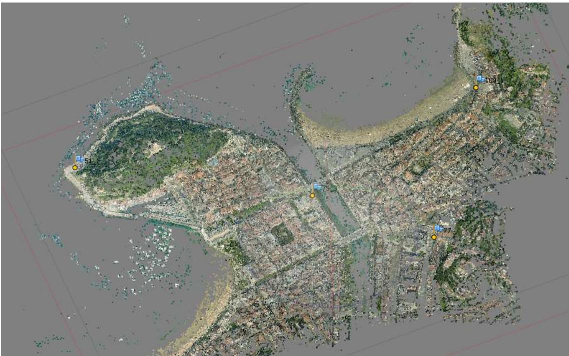
Figura 18: Nube de puntos dispersa tras optimizar orientaciones cámara
