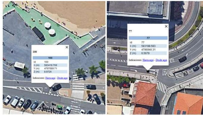
Figura 12: Localización de puntos de apoyo vistos en Google Earth
