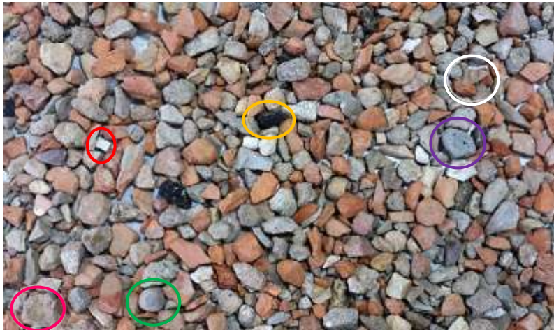
Figura 20: Tanda de RCD's indicando: ladrillo, mortero, hormigón, loza y alquitrán.
