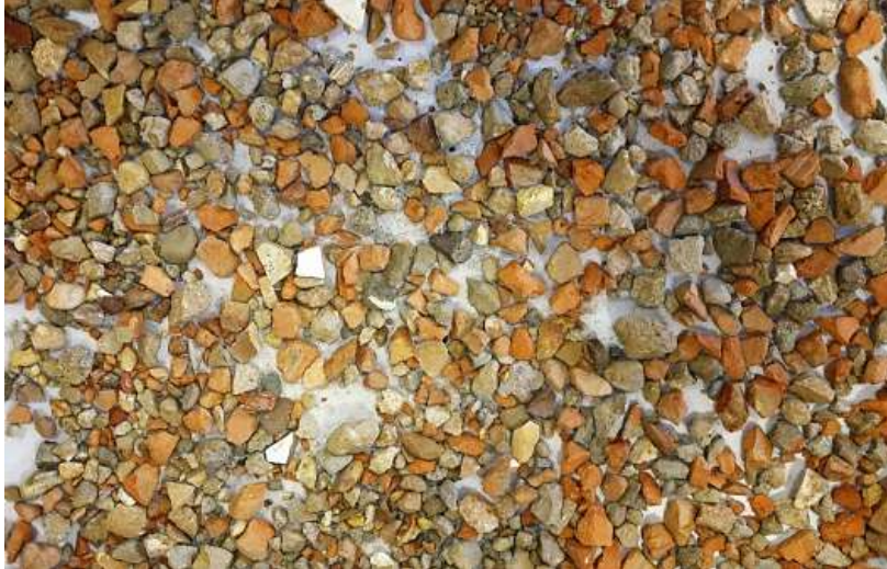
Figura 22: Mezcla de ladrillo, mortero y hormigón limpios de impurezas.
