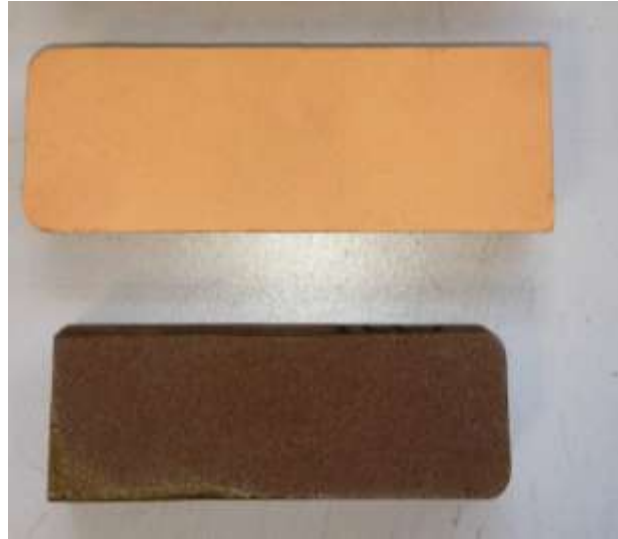
Figura 117: Contracción observada en una pieza moldeada y sinterizada a 1300°C.
