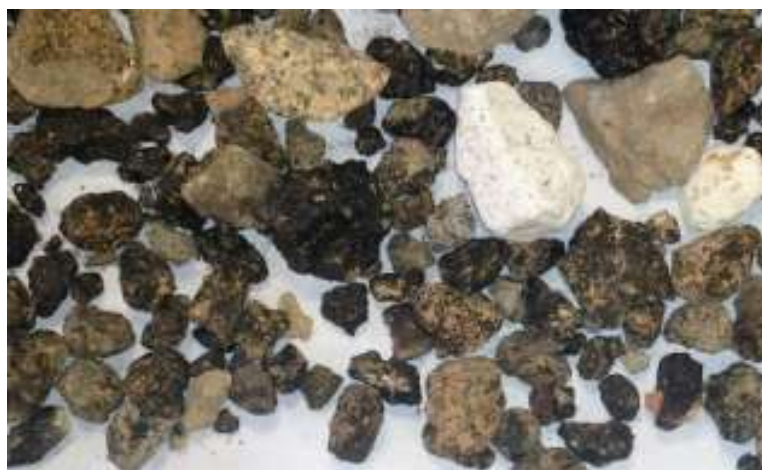
Figura 21: Impurezas separadas manualmente: grava impregnada con alquitrán, yeso, vidrio, etc.
