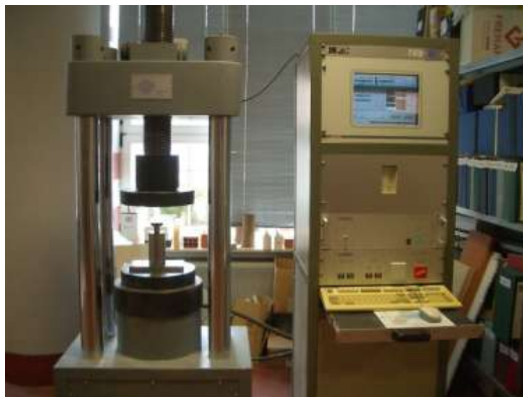
Figura 39: Prensa hidráulica empleada en el proceso de compactación.
