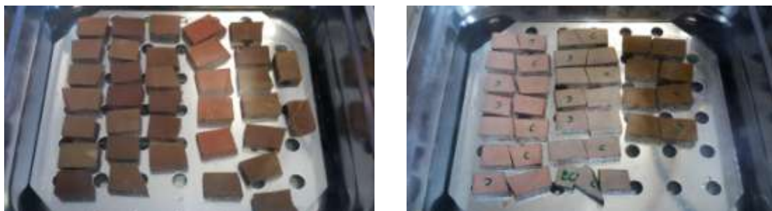
Figura 66: Detalle de ensayo de absorción. a) Piezas 100% RCD's, b) piezas 50% RCD's y 50% caolín, y 50% RCD's y 50% cemento.
