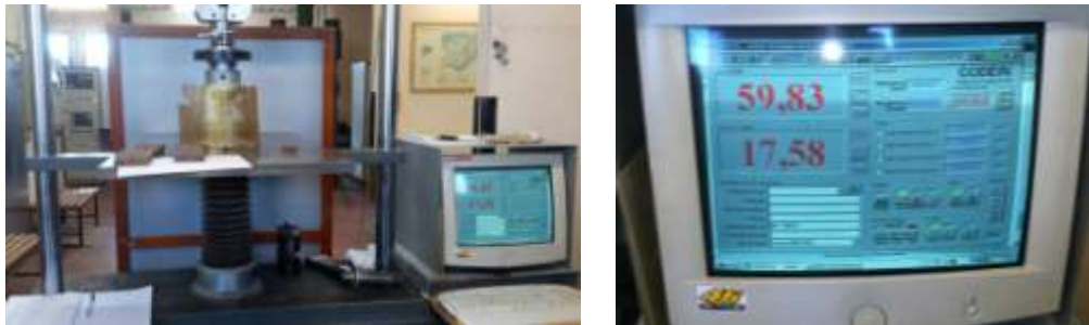
Figura 62: a) Máquina universal realizando el ensayo. b) Software de adquisición de datos.
