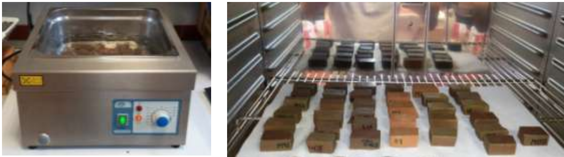
Figura 65: a) Cuba utilizada en ensayo de absorción y b) piezas en el interior del horno de secado.
