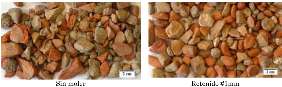
Figura 73: RCDs en estado de suministro y retenido #1mm.
