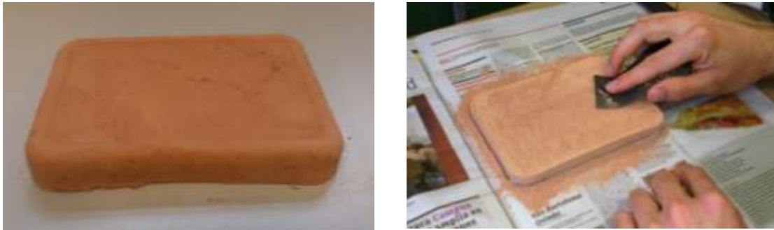
Figura 37: a) Pieza en verde y b) operación de acondicionamiento.
