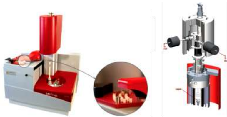
Figura 30: Aspecto del equipo TGA/DSC Labsys evo Setaram [165].
