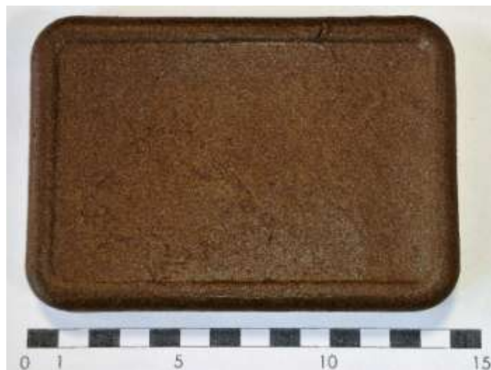
Figura 160: Pieza fabricada por moldeo y de forma rectangular sinterizada a 1130°C [cm].
