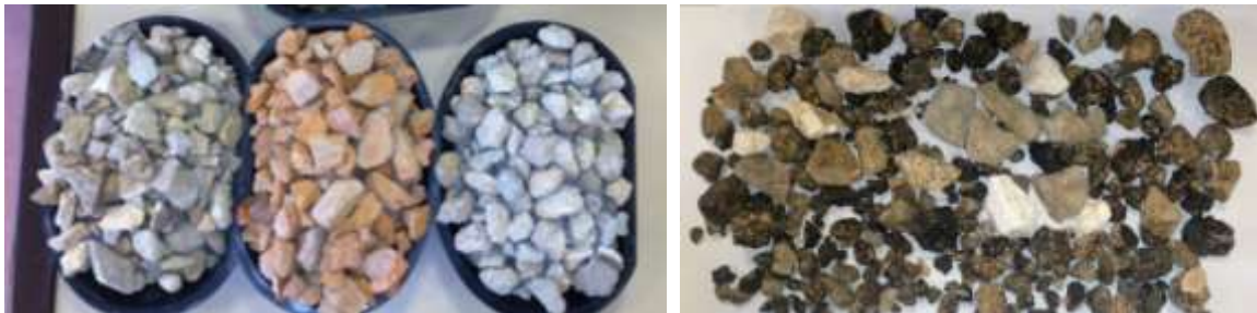
Figura 70: a) Proporción relativa de los RCD's, hormigón, ladrillo y mortero del lote 1 y b) separación del yeso y alquitrán.
