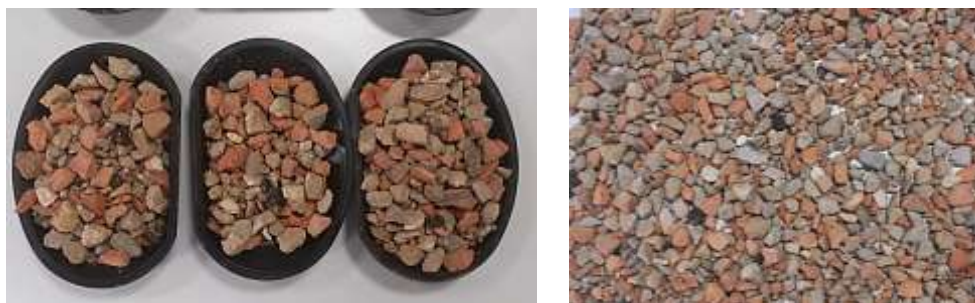
Figura 19: a) RCD's limpios y secos y b) Tanda de RCD's.
