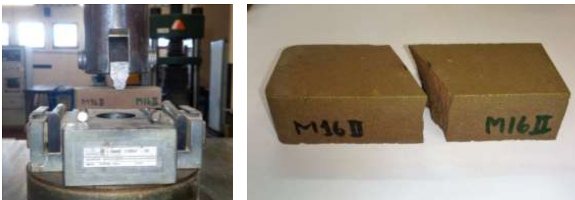
Figura 63: a) Útil para el ensayo a flexión. b) Pieza fracturada a flexión.
