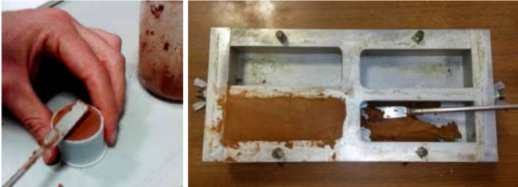
Figura 32: Detalles de la operación de llenado de los moldes a) teflón y b) metálico.
