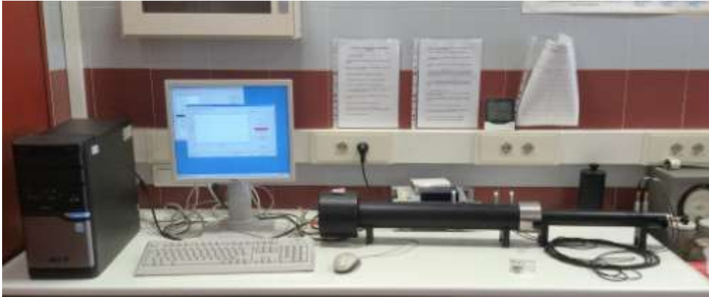
Figura 60: Tubo de impedancia acústica.
