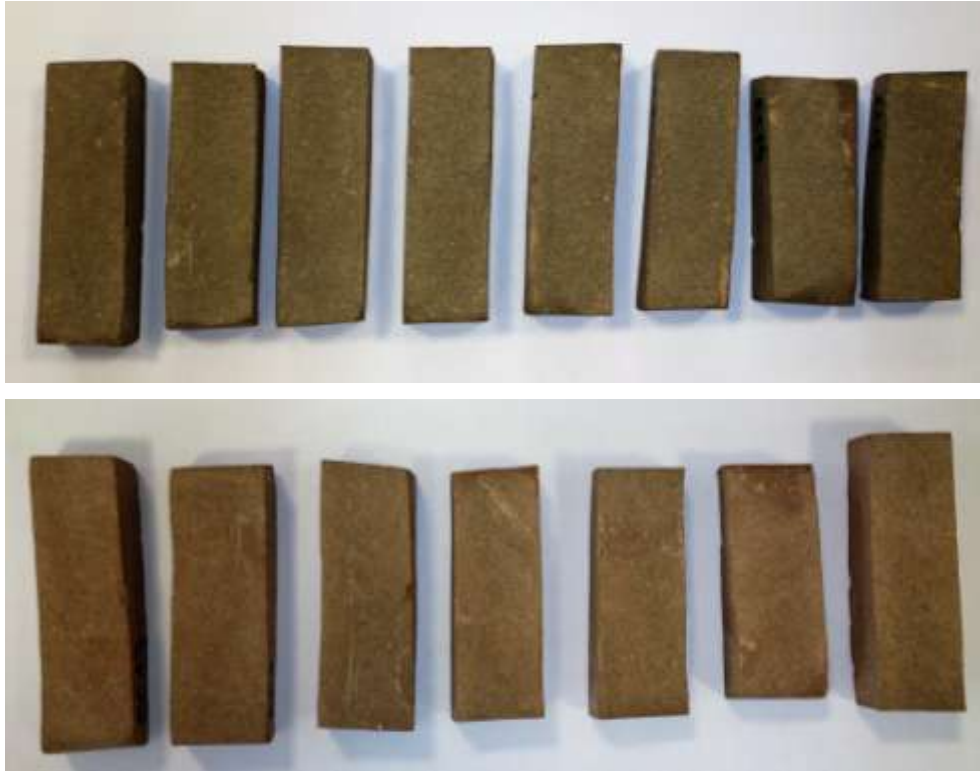
Figura 171: Piezas sinterizadas a la temperatura de 1200°C (arriba) y 1185°C (abajo).
