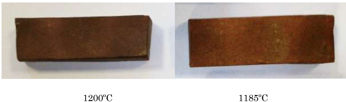
Figura 172: Cara en contacto con el material refractario del horno.
