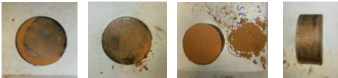
Figura 40: Probetas desechadas por defectos de extracción.
