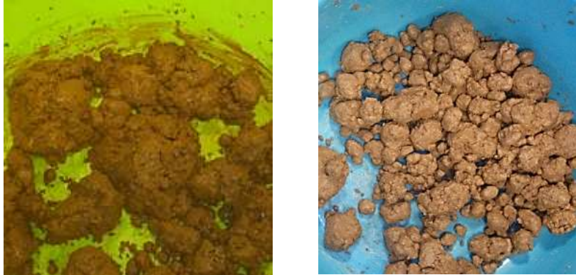
Figura 42: Amasado de las mezclas a) RCD's y b) 50% RCD's + 50% caolín.
