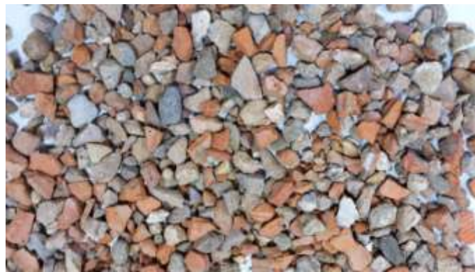
Figura 69: Residuos de Construcción y Demolición.
