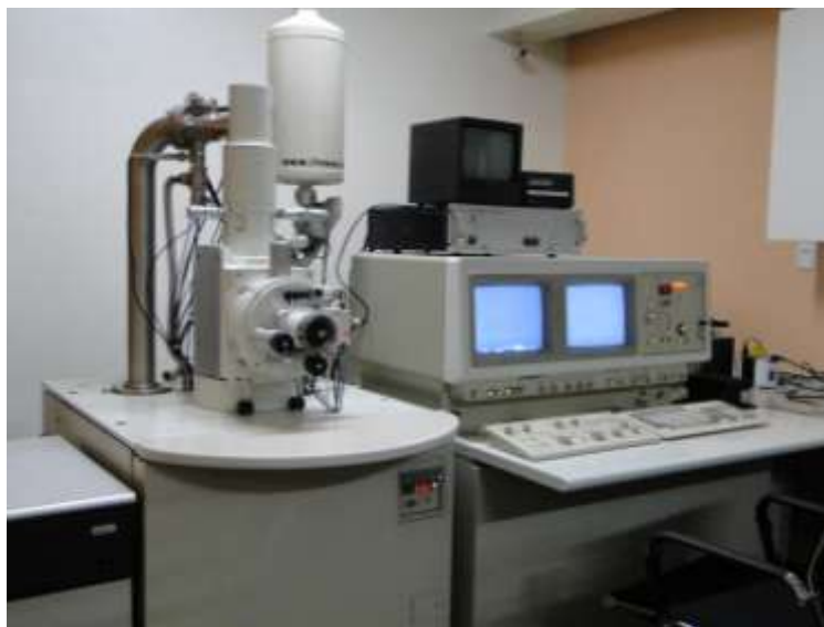
Figura 68: Microscopio electrónico empleado modelo Jeol JSM 6300 [192].
