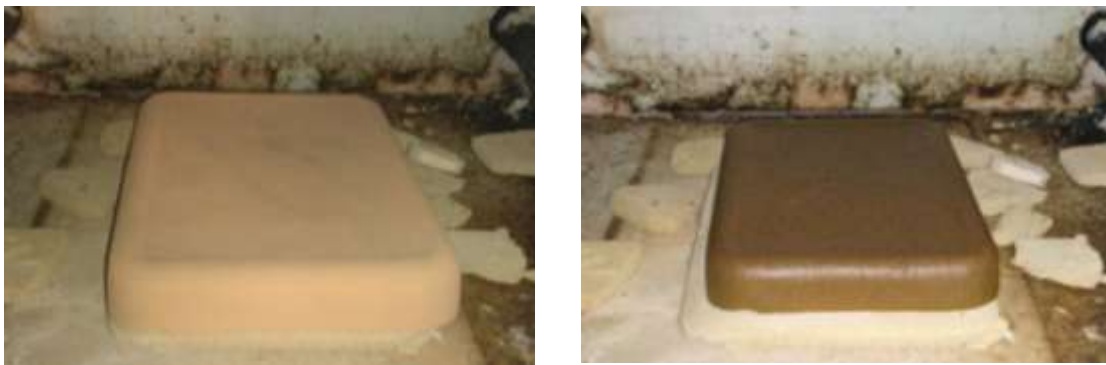
Figura 51: Pieza de 100%RCDs a) antes y b) después de sinterización.
