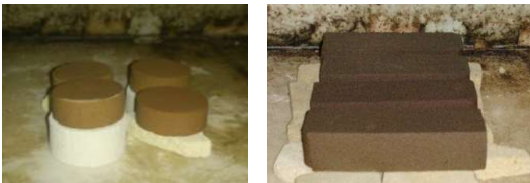
Figura 48: Piezas 100% RCD's: a) cilíndricas a 1100°C y b) rectangulares a 1130°C.
