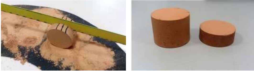
Figura 34: a) Operación de corte y b) comparación pieza sin corte frente a pieza cortada.
