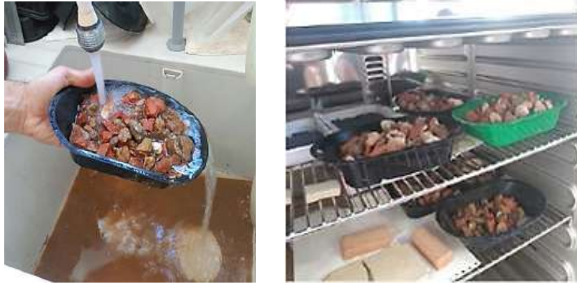
Figura 18: a) Lavado de los RCD's y b) Secado de los RCD's. c) RCD's limpios y secos.
