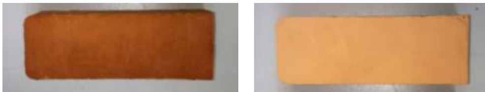
Figura 35: a) Pieza antes de mecanizado. b) Pieza después de un ligero mecanizado superficial.
