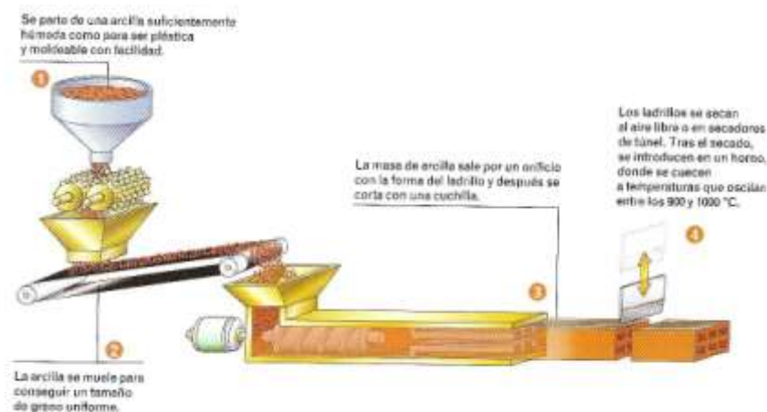
Figura 9: Esquema del proceso de extrusión [106].
