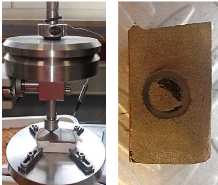
Figura 56: a) Detalle ensayo tribológico. b) Pista de desgaste en pieza de RCD's a 1130°C.
