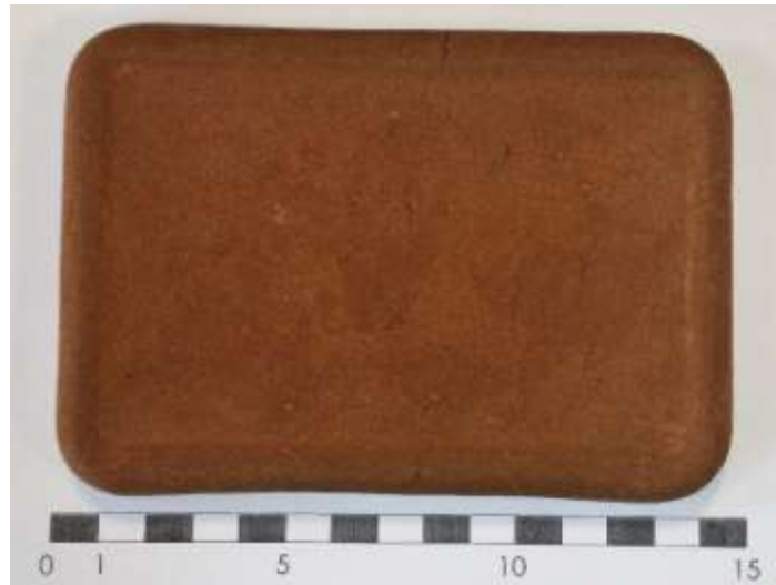
Figura 161: Pieza fabricada por moldeo y de forma rectangular sinterizada a 1100°C [cm].
