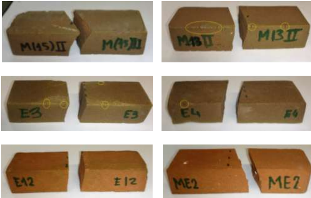
Figura 134: Piezas ensayadas a flexión simple, conformadas por moldeo y extrusión y sinterizadas a 1130°C y a 1100°C.
