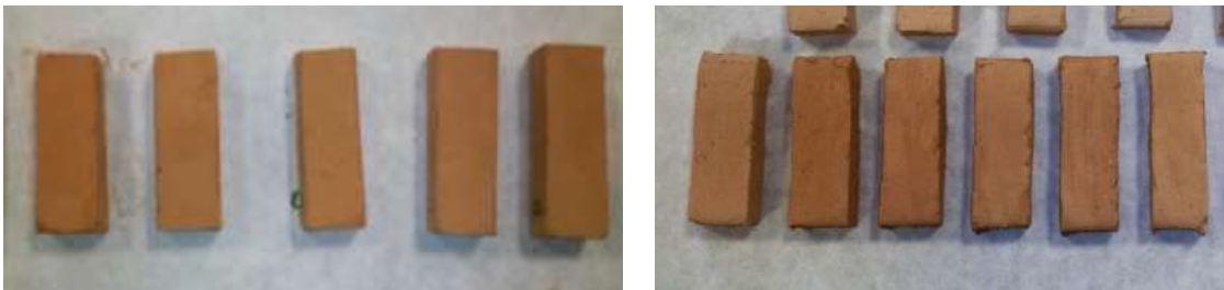
Figura 44: Algunas de las piezas obtenidas por extrusión, en estado húmedo.
