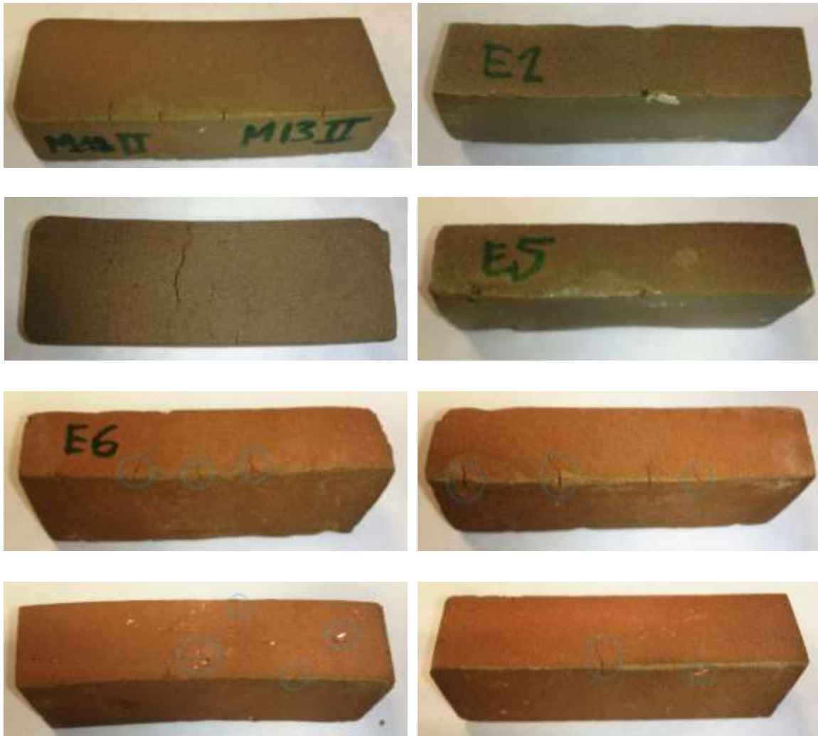
Figura 121: Defectos observados en las piezas rectangulares, moldeo y extrusión.
