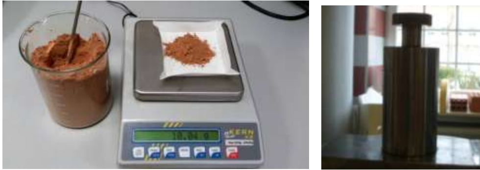
Figura 38: a) Pesaje de la cantidad de material empleado en cada pieza y b) matriz utilizada.
