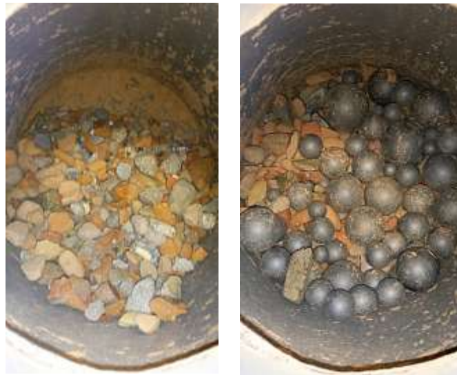
Figura 24: a) RCD's en el interior del molino y b) bolas junto con los RCD's.
