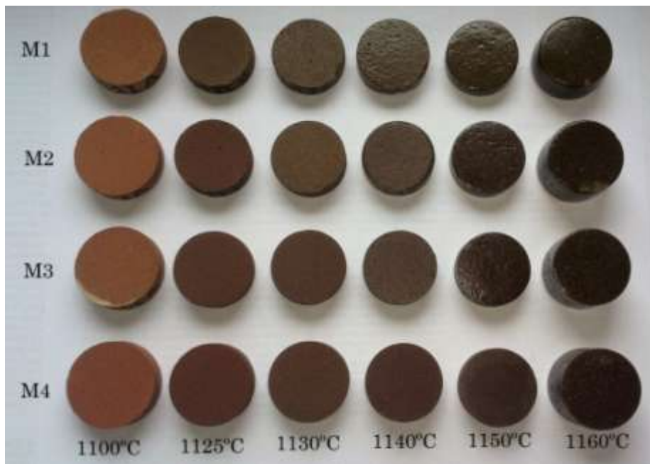
Figura 91: Evolución de las piezas fabricadas a partir de las moliendas M1 – M4 a las diferentes temperaturas.
