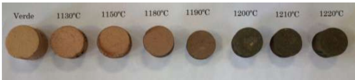
Figura 165: Evolución del material mezclado (RCDs + caolín) durante el proceso de sinterización.
