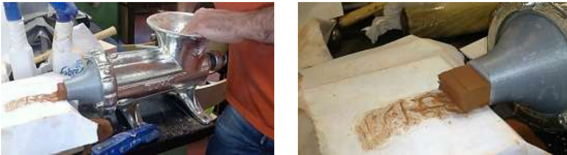
Figura 43: a) y b) Detalles de la operación de extrusión.
