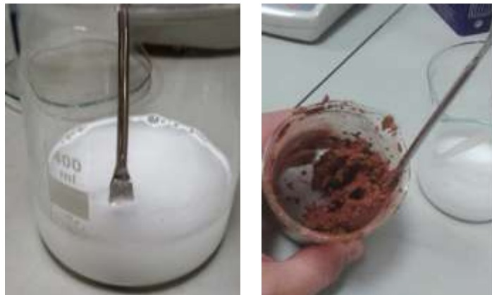
Figura 31: a) Mezcla de ligante con agua destilada, b) operación de mezcla con la suspensión.
