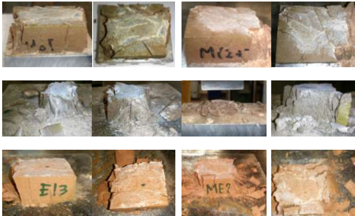
Figura 136: Ensayos a compresión simple sobre piezas fabricadas por moldeo y extrusión, sinterizadas a 1130°C y 1100°C.
