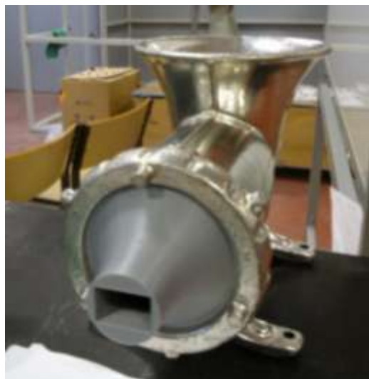
Figura 41: Mini-extrusora adaptada para este estudio.
