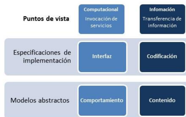
Figura 4-6 Puntos de vista y niveles de abstracción en el Modelo de Referencia de Interoperabilidad Espacial GIRM del FGDC
