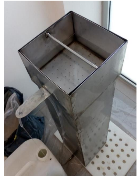
Figura 10. Filtro de bio-arena instalado en el IBFG, construido en acero inoxidable.
