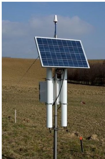
Figura 1.13. Sensor de rayos cósmicos para medir la humedad del suelo. Imagen tomada de http://cosmos.hwr.arizona.edu/
