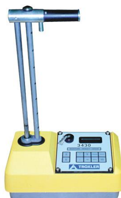
Figura 1.9. Sensor de medición de la humedad RoadReader Model 3430 Moisture-Density Gauges (TroxlerLab, Inc.) que utiliza el método de atenuación de rayos gamma. Imagen tomada de www.troxlerlabs.com .
