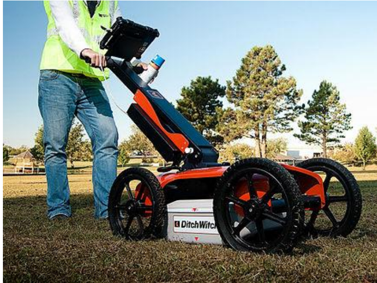
Figura 1.12. Sensor GPR 2450GR (Ditch Witch, Inc.) tomando medidas de humedad del suelo. Imagen tomada de www.ditchwitch.com .
