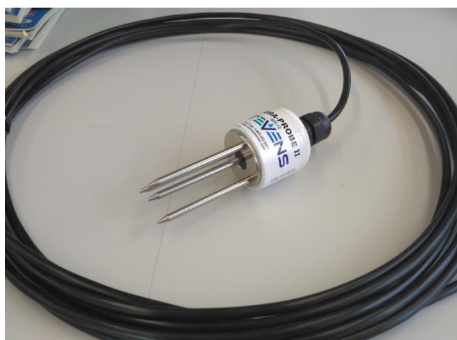
Figura 1.11. Sensor de capacitancia Hydra-Probe , de la marca Stevens Water Monitoring System Inc.
