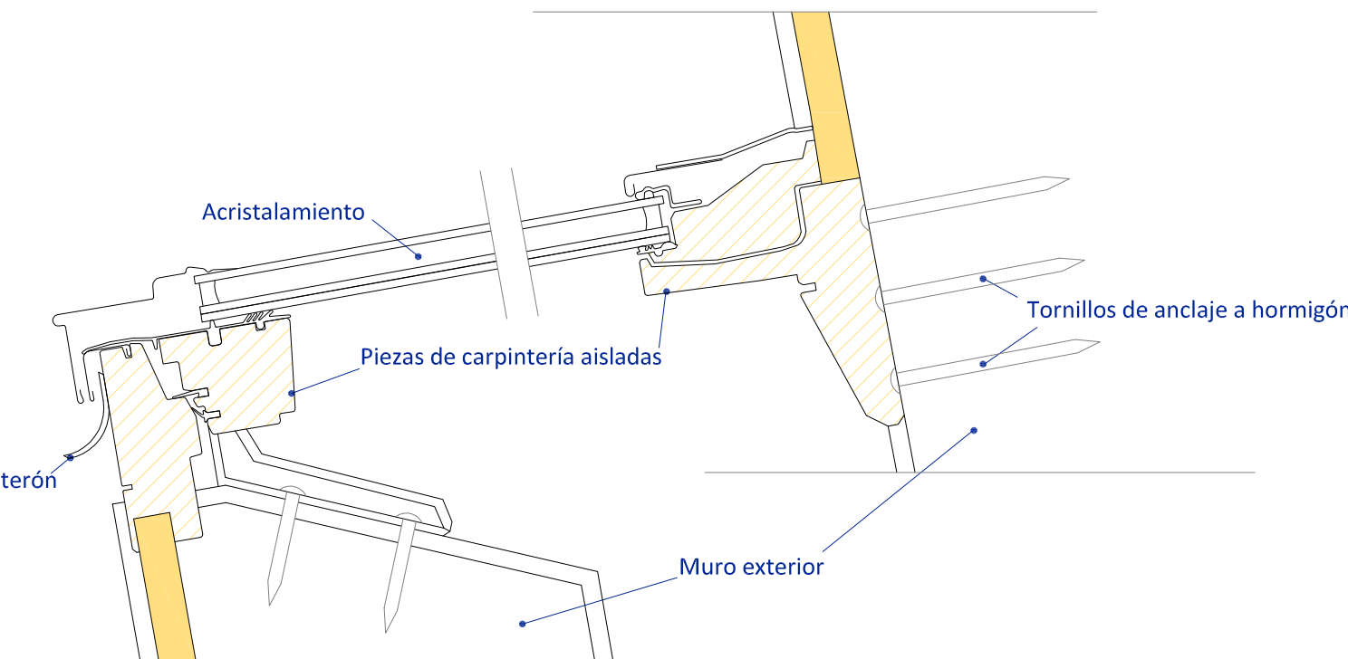
Detalle Anclajes de lucernarios
