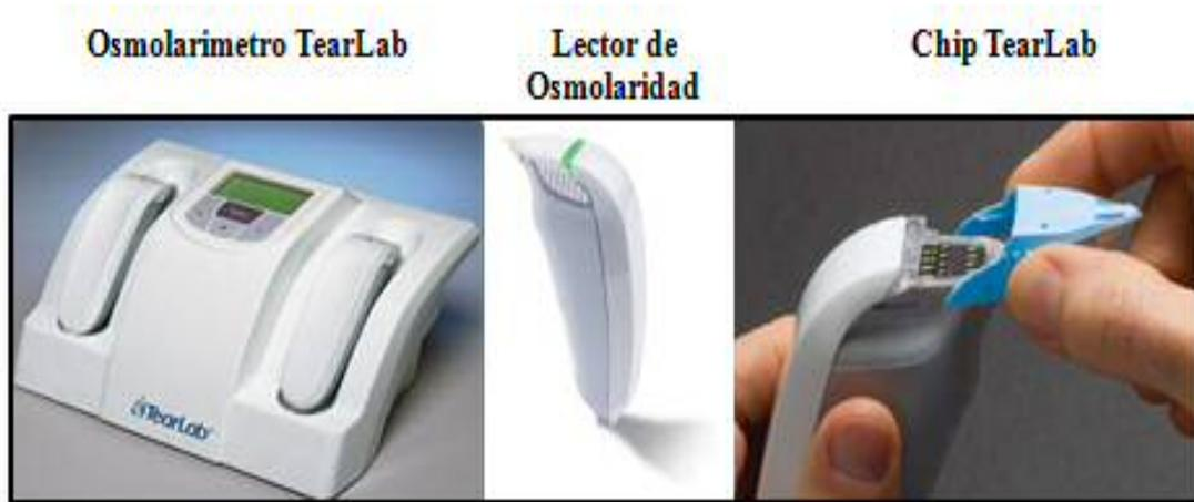
**Fig. 26.** Imagen del osmolarímetro TearLab y de los chips empleados en cada medición.
