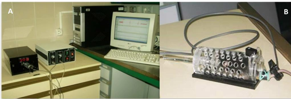
Figura 9. Equipo NIPREM 1.5. y ratón en el cepo de medida. A) sistema computerizado PowerLab/800 para Windows (Cibertec S.A) que permite la monitorización y obtención de valores de PAS y de FC. B) Imagen de un ratón durante el periodo de acostumbramiento en el cepo.
