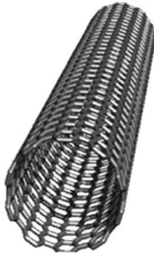
**Figura 1.6** Estructura de un Nanotubo de Carbono de Pared Simple (SWCNT) [67].
