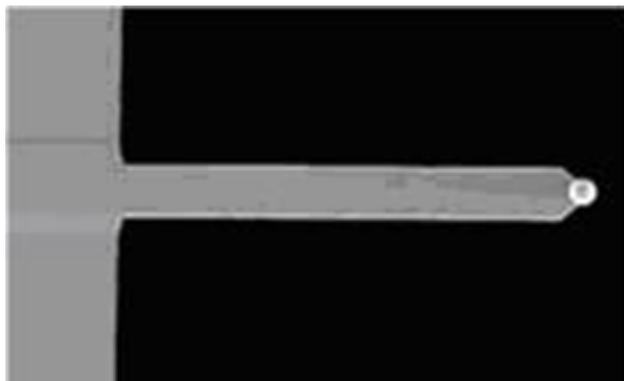
**Figura 3.10** Micrografía SEM de la palanca y punta coloidal CPFM\_SiO<sub>2</sub>-A/Au (NT-MDT®) [33].
