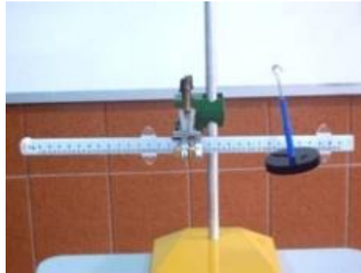
Figura 1: Montaje experimental del péndulo (fuente: (Fisquiweb, Consultado en Mayo 2018)).
