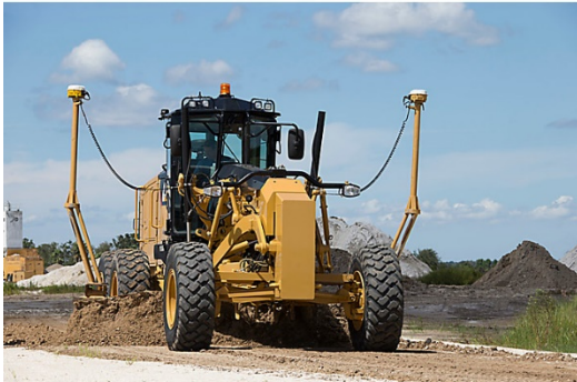
Figura 20. Motoniveladora con sistema GPS embarcado. Fuente: Caterpillar
