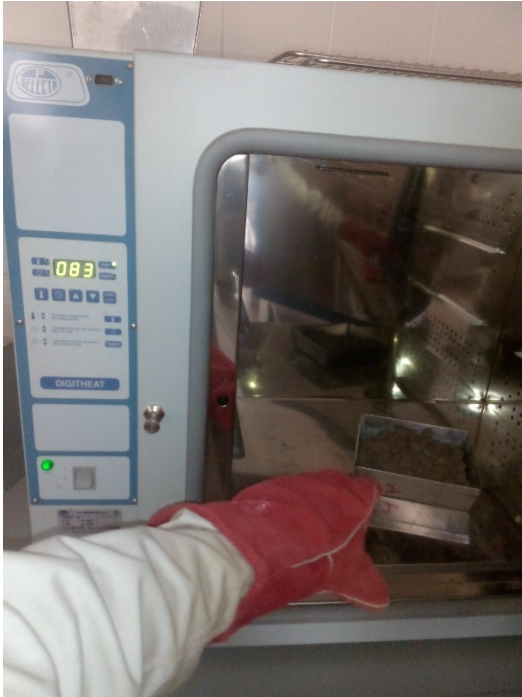
Figura 6. Introducción de material para determinar la humedad en estufa de la EPSZ. Fuente: propia
