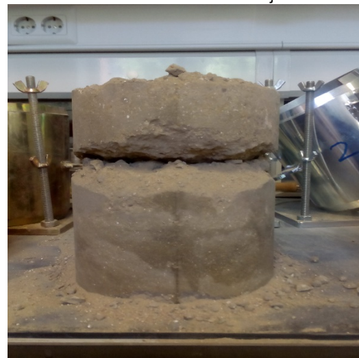
Figura 1. Fractura por capa durante la manipulación de la probeta. Consecuencia de la ausencia de una matriz estructural correctamente desarrollada.
