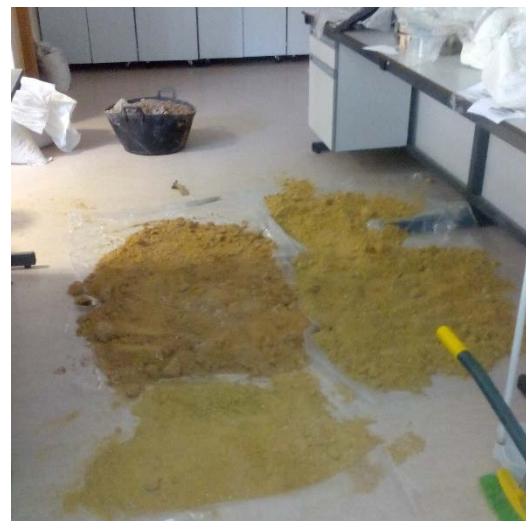
Figura 1. Secado del suelo del Préstamo de la LAV en la Hiniesta. Fuente: propia
