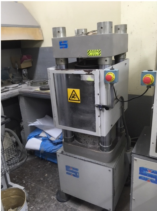
Figura 22. Prensa para llevar a cabo las roturas a compresión simple. Fuente: propia
