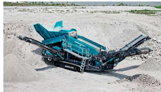
Figura 5. Criba móvil sobre orugas. Fuente: Powerscreen
