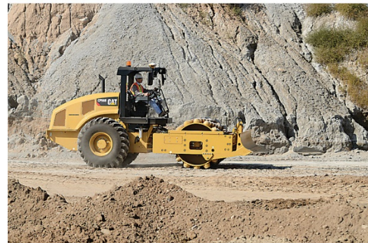
Figura 17. Compactador pata de cabra. Fuente: Caterpillar
