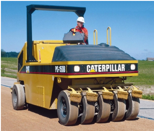
Figura 18. Compactador de neumáticos. Fuente: Caterpillar
