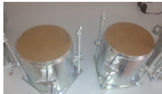
Figura 10. Probetas confeccionadas en la EPSZ con molde de 152,4x177,8mm. Fuente: propia
