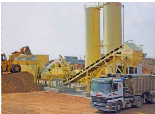
Figura 3. Planta de suelocemento. Fuente: Intrame
