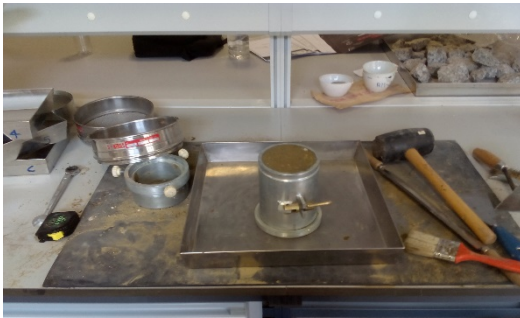
Figura 17. Ensayo de determinación de la humedad óptima y la densidad máxima por el Próctor Modificado. fuente: propia
