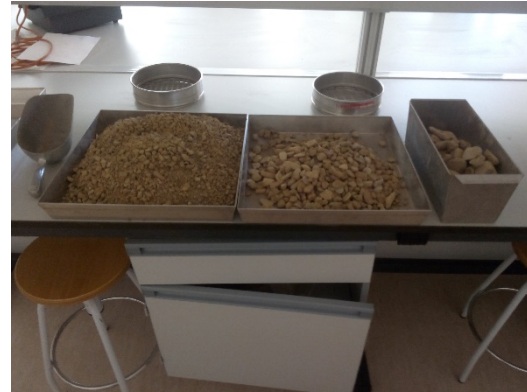
Figura 15. Separación de materiales por tamizado. Fuente: propia
