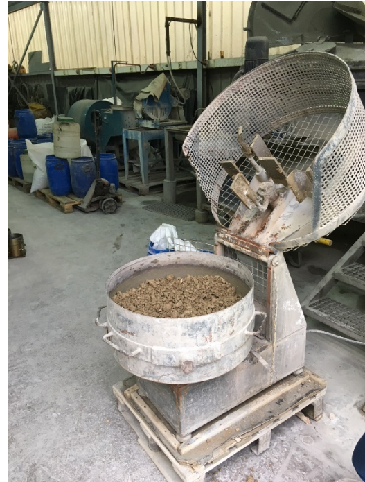
Figura 7. Amasadora de 200 lts. de capacidad empleada en las instalaciones de Cementos Molins. Fuente: propia
