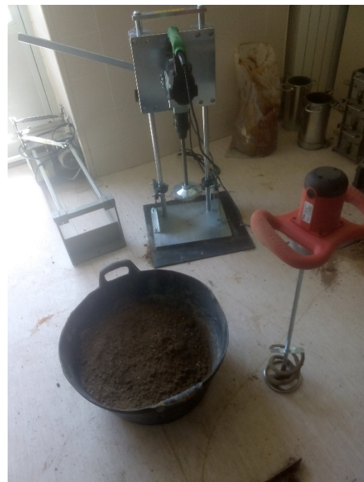
Figura 5. Cubo con material ya homogeneizado y batidor empleado en la EPSZ. Fuente: propia
