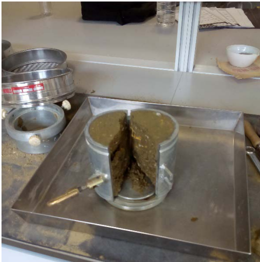
Figura 12. Ensayo Próctor Normal realizado en el marco de la presente investigación sobre materiales que cumplían prescripciones para ser ensayados mediante este método. Fuente: propia
