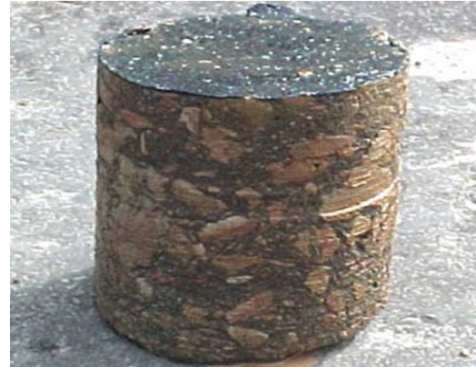
Figura 1. Probeta de CTB. Fuente: PCA
