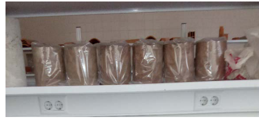
Figura 18. Probetas curadas en bolsa hermética en el laboratorio. Fuente: propia
