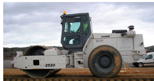
Figura 16. Compactador vibratorio liso mixto. Fuente: Triexplanada
