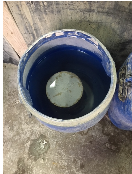
Figura 24. Probetas sumergidas durante 48h. Fuente: propia
