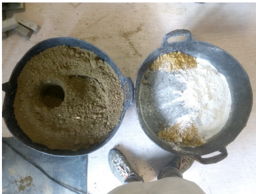
Figura 9. A la izda. Material ya mezclado y homogeneizado. A la dcha. mezcla de suelo, polímeros y cemento antes de ser amasada. Fuente: propia
