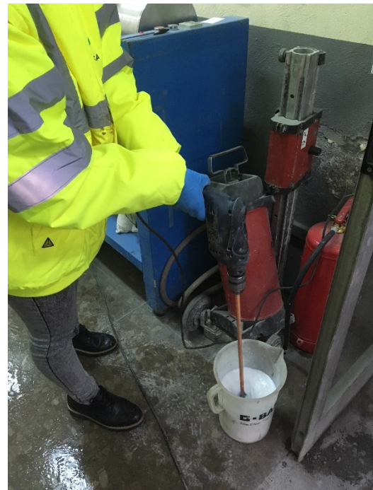
Figura 2. Disolución del polímero con batidora eléctrica para garantizar la correcta dilución en agua. Fuente: propia
