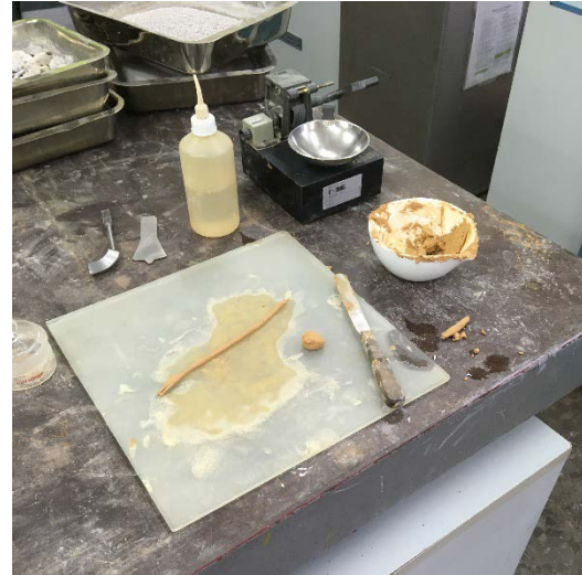
Figura 16. Ensayo de determinación del límite plástico. Fuente: propia
