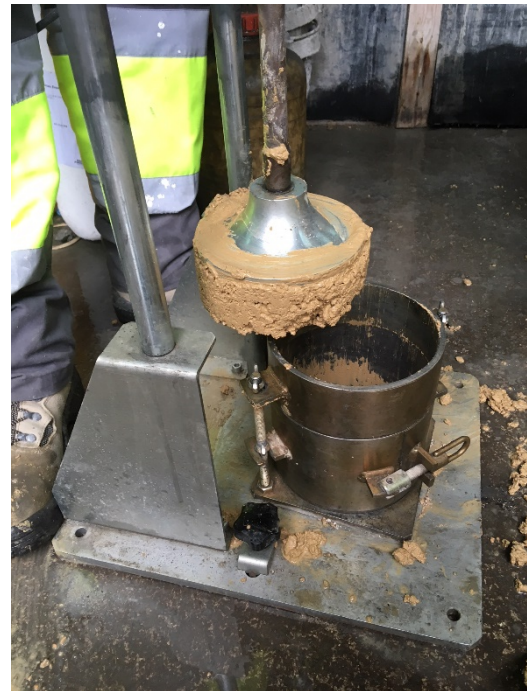
Figura 2. Dificultades para trabajar el material incluso en laboratorio. Un comportamiento así en obra impide el empleo de rodillos lisos.
