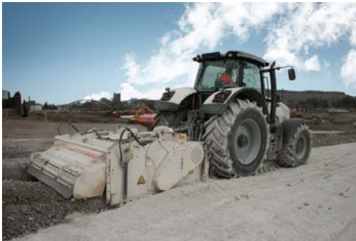
Figura 15. Estabilizador accionado por tractor. Fuente: Wirtgen
