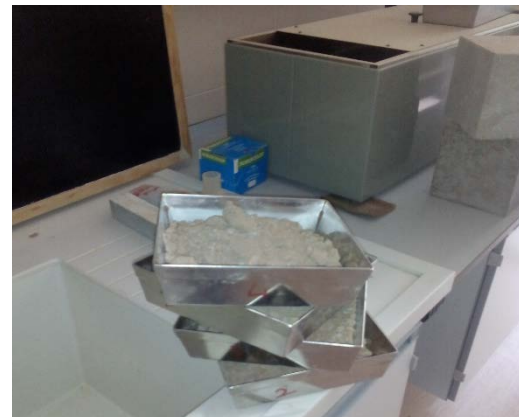
Figura 19. Bandejas con material ya seco en estufa para determinar su humedad. Fuente: propia
