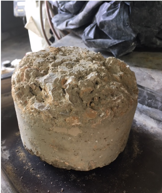
Figura 27. Excelente resultado de una probeta sometida al ensayo de desgaste. Fuente: propia
