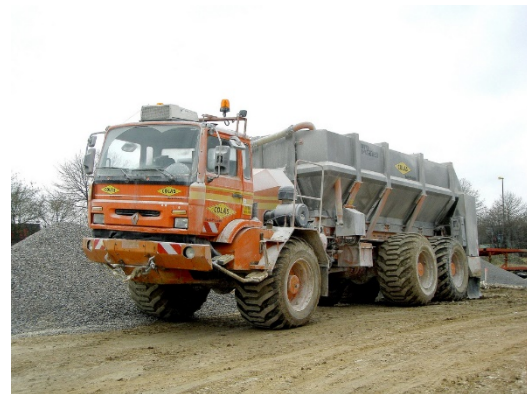
Figura 6. Dosificador de conglomerantes autopropulsado. Fuente: COLAS
