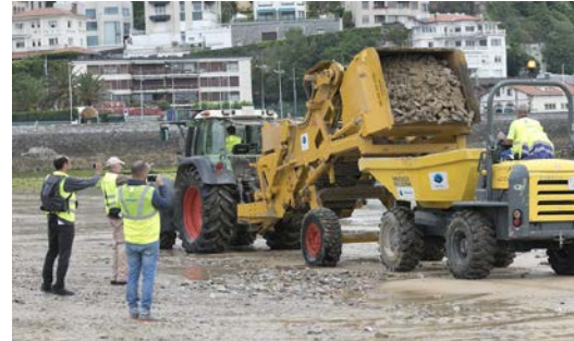
Figura 2. Máquina despedregadora. Fuente: Diario Vasco
