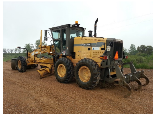
Figura 3. Motoniveladora con ripper. Fuente:
