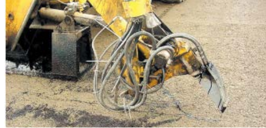
Figura 21. Detalle de la uña empleada en el sistema CRAFT. Fuente: ATC-PIARC
