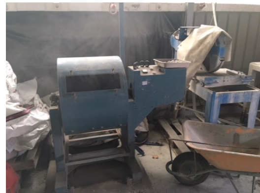
Figura 11. Máquina de desgaste de Los Ángeles. Fuente: propia
