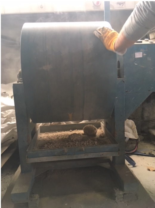
Figura 4. Se observa en la bandeja de la máquina de desgaste de Los Ángeles la fracción #50mm para un suelocemento al 3% de cemento
