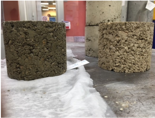
Figura 25. Comparativa de la probeta sumergida y la curada en cámara húmeda. Fuente: propia
