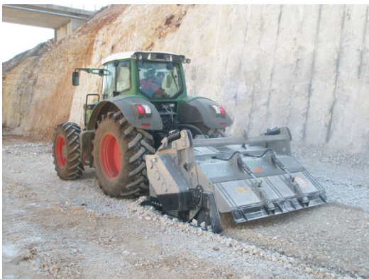
Figura 4. Trituradora de piedra trabajando sobre fondo de desmonte. Fuente: FAE
