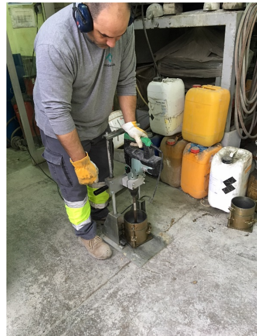
Figura 8. Compactación de probetas cilíndricas mediante martillo vibratorio en el laboratorio de Cementos Molins. Fuente: propia
