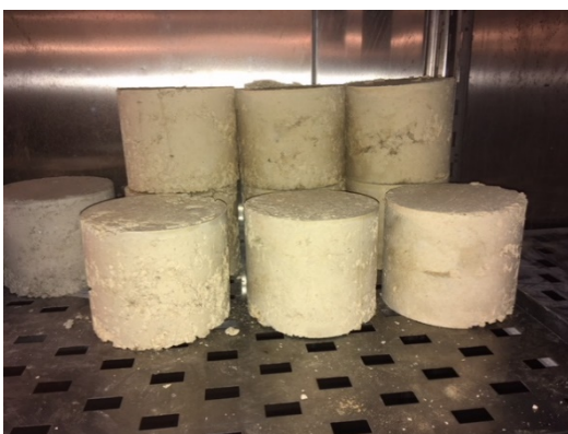
Figura 13. Probetas conservadas en cámara húmeda. Fuente: propia
