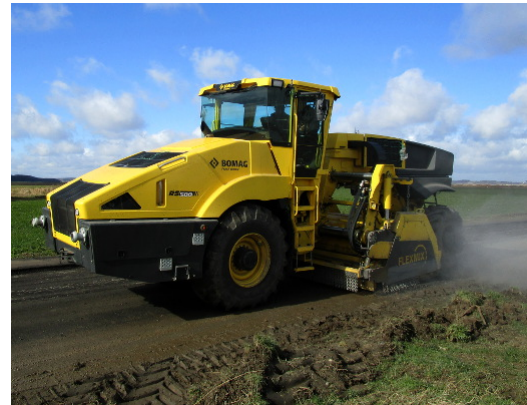
Figura 14. Máquina estabilizadora autopropulsada con motor trasero. fuente: Bomag
