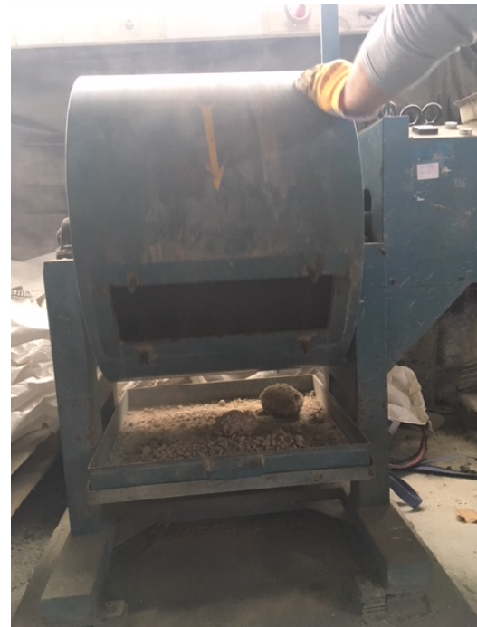
Figura 26. Material a la salida del ensayo cántabro con 100 revoluciones. Fuente: propia
