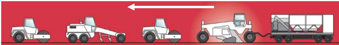
Figura 1. Resumen gráfico del procedimiento constructivo para ejecutar suelocemento in situ. Fuente: SOLTEC
