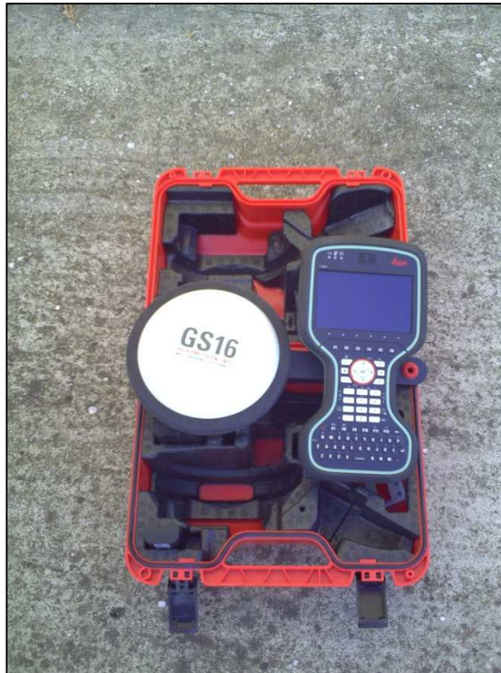
Imagen 32.- Receptor Leica CS 20 y antena GS16 utilizados
