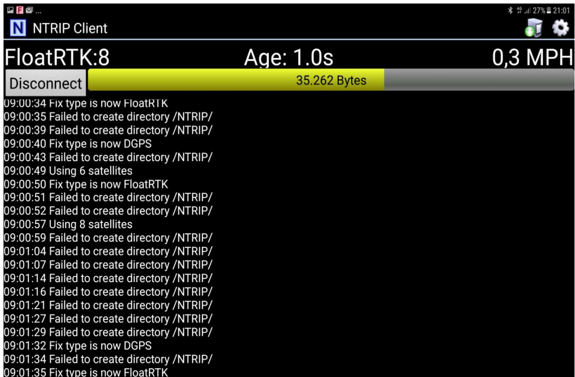
Imagen 15.- Aplicación Lefebure enviando correcciones diferenciales vía Bluetooth al receptor GPS
