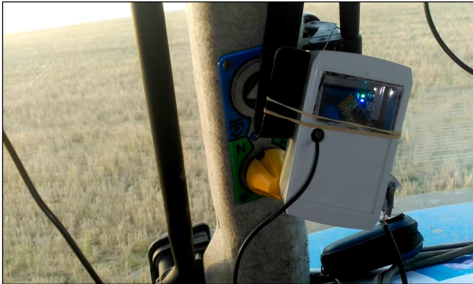
Imagen 38.- Receptor GPS y Bluetooth dentro de caja protectora en cabina tractor
