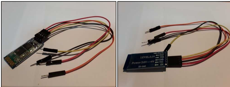
Imagen 14.- Bluetooth HC-06 con los cables de conexión al receptor u-Blox
