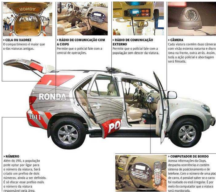
Figura 8. Equipo tecnológico de los coches patrulla
