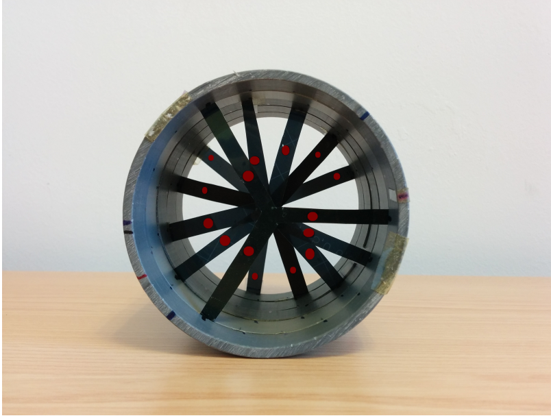
Figura 4.4: Detector construido con un cilindro de radio 4 cm para la medida de dosis en el intervalo de distancias a la fuente 4.5–12.5 cm. Los TLD se situaron en los puntos de color granate indicados.
