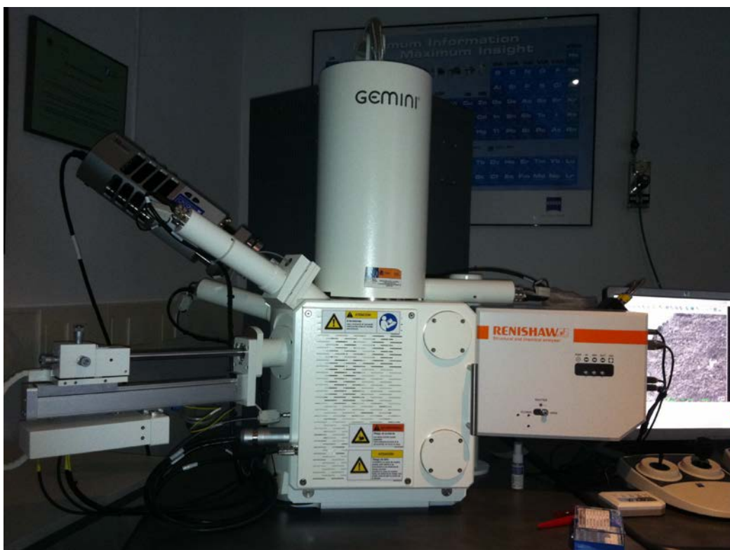
Figura 16. Microscopio electrónico de barrido de presión variable de alta resolución ZEISS modelo SUPRA 40VR.
