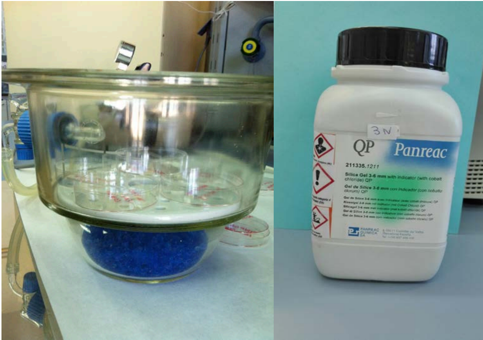
Figura 14a y 14b. Cámara de sílice al vacío y gel de sílice.
