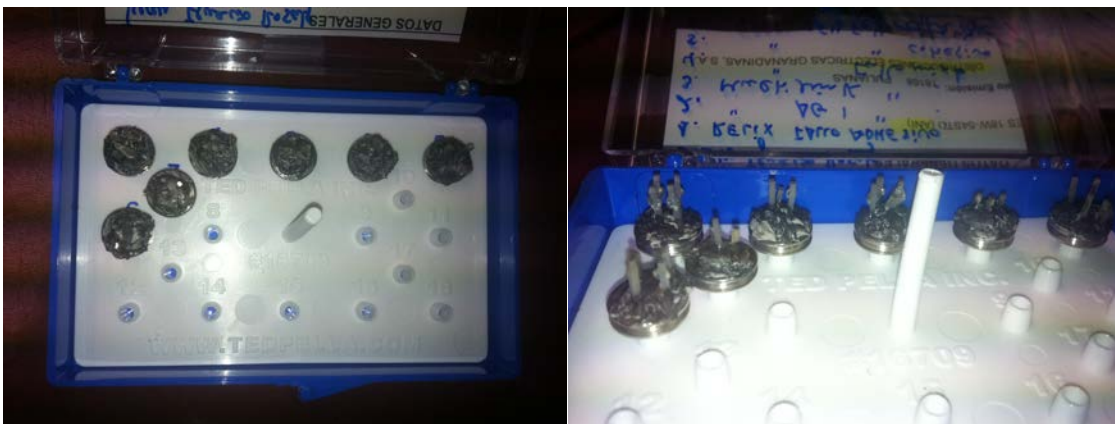
Figura 15. Portamuestras de microscopio electrónico de barrido (SEM) de aluminio con muestras revestidas de pulverización de carbón.
