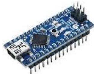
Figura 1. Placa Arduino Nano.
