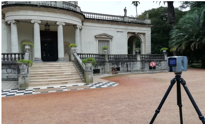
Imagen 14: Escaner TX5 instalado en fachada frontal (Fuente propia)
