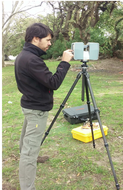
Imagen 8: Escaner Trimble TX5 (Fuente propia)
