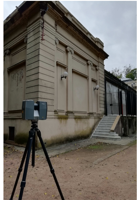
Imagen 13: Escaner TX5 instalado en esquina posterior (Fuente propia)
