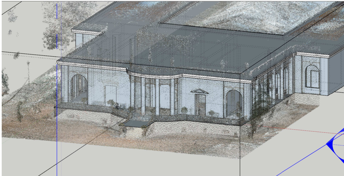
Imágen 50: Modelo en construcción con nube de puntos - SketchUp (Fuente propia)
